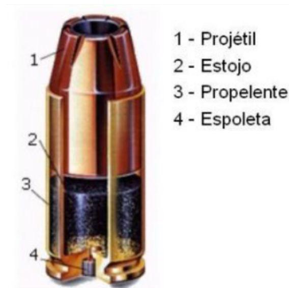
Figura 5 – Esquema de munição encartuchada [8].
