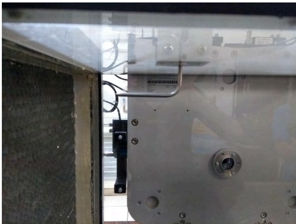
Figura 41 – Tubo de Pitot utilizado para a medição da velocidade do escoamento de ar.
