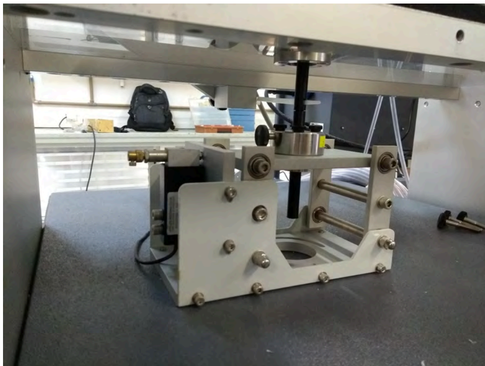
Figura 39 – Balança utilizada para a medição da força de arrasto.
