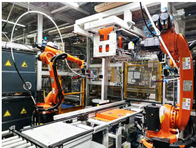
Figura 4 – Exemplo de robô antropomórfico em uma linha de montagem (10).
