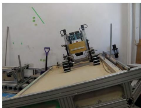
Figura 49 – Terreno angulado na transversal (44)
