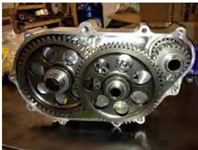
Figura 8 – Exemplo de redução fixa como a utilizada na modelagem. Fonte:Fórum BAJA SAE
