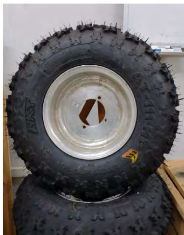
Figura 34 – Pneu com ranhuras utilizado no veículo modelado Fonte: Laboratório BAJA IME
