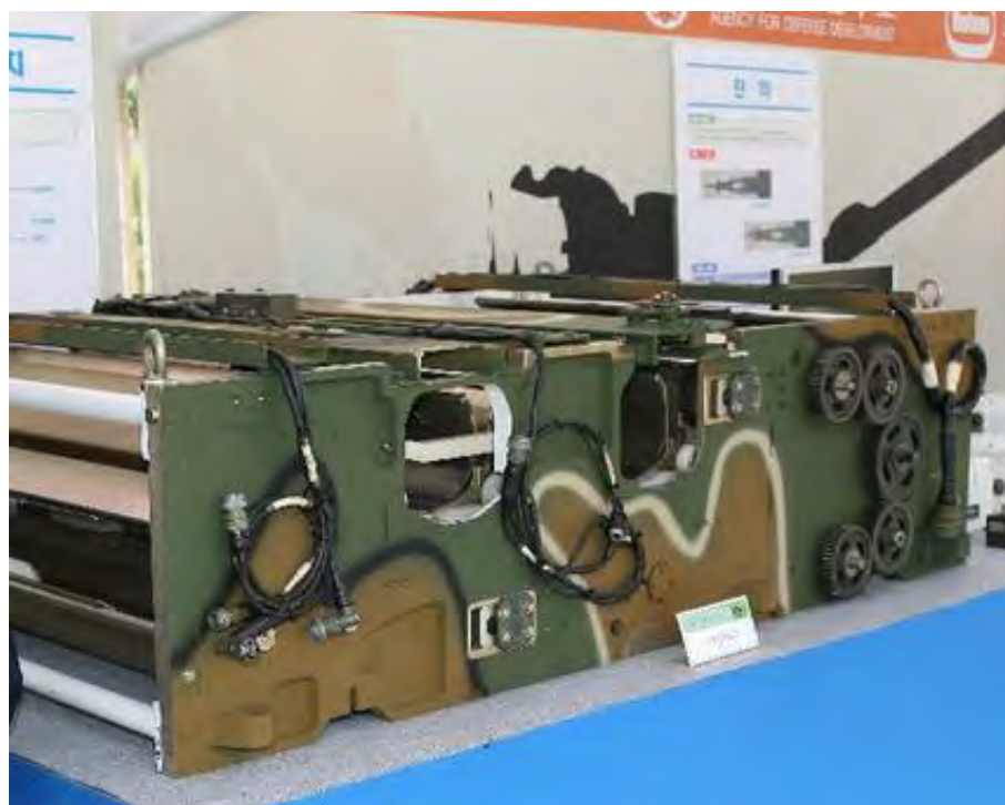
Figura 3.12 Carregador automático presente no K2 Black Panther (Fighting Vehicles, 2020)
