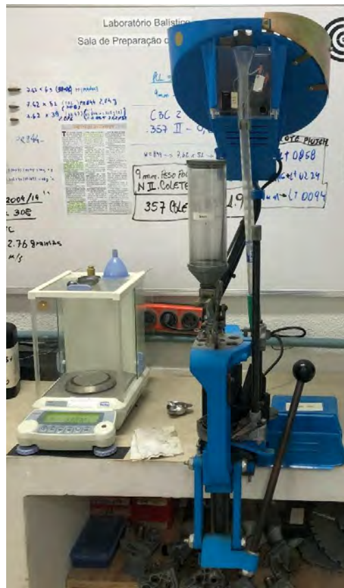
Figura 4.7: Máquina de montagem de cartucho ao centro e balança utilizada para verificar quantidade de pólvora adicionada à esquerda.
