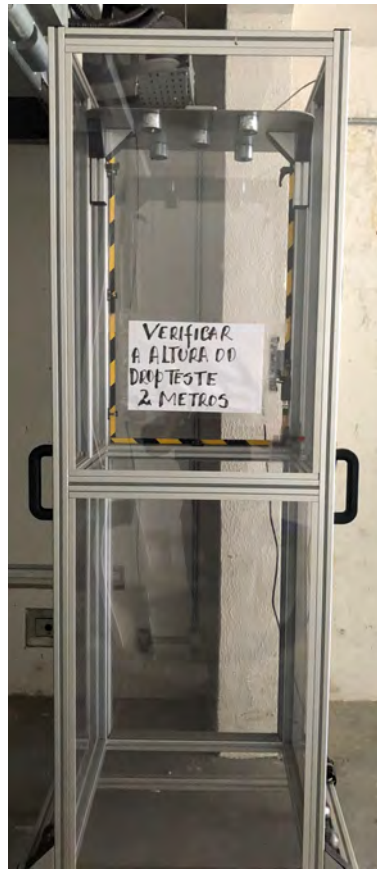
Figura 4.8: Aparelho de eletroímã utilizado no teste de queda.
