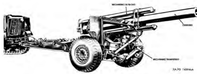
(a) Obuseiro 155-mm na posição de transporte. Editado de Department of the Army (1953).
