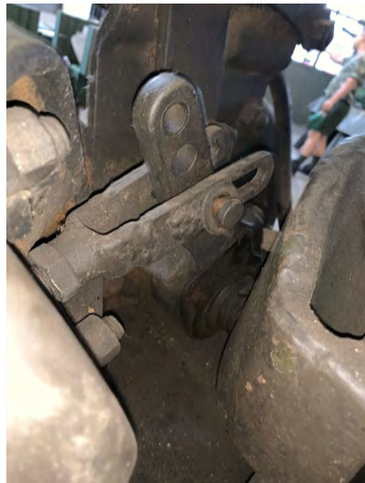
(b) Pistão do atuador pneumático e Slack (visão aproximada).
