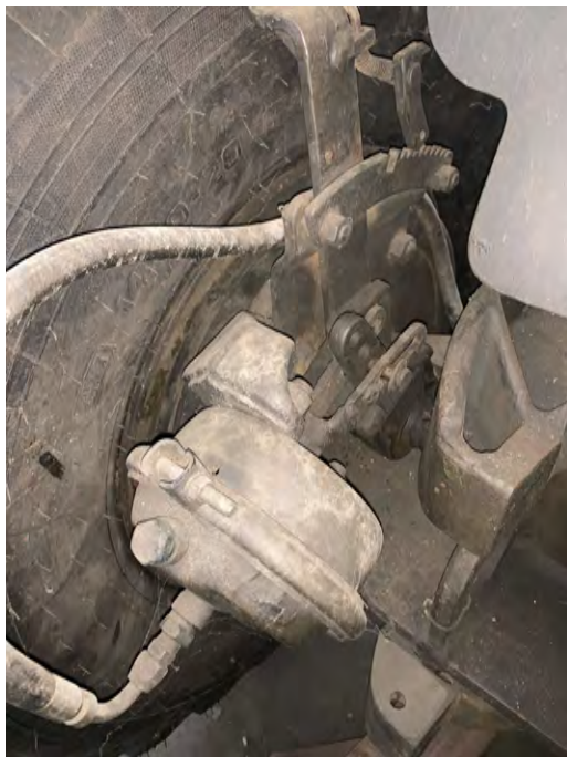
(a) Atuador pneumático e seu pistão ligado ao Slack
