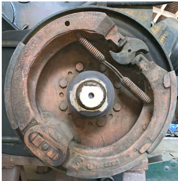
Figura. 3.6: Mecanismo de acionamento "S-Cam" do obuseiro: came em forma de "S", sapatas e lonas.
