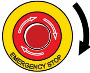
Figura 52 – Desarmando o botão de parada de emergência
