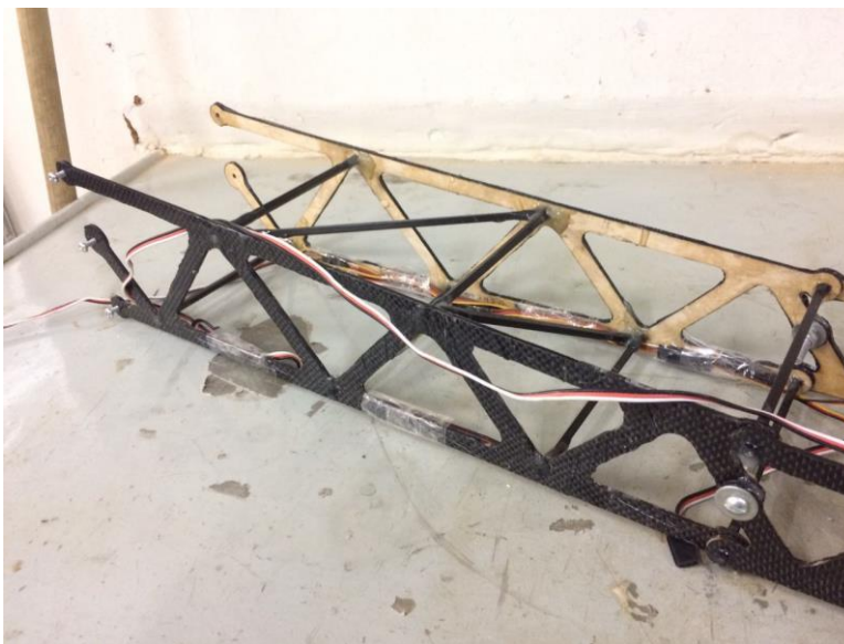
Figura 45. Tail-boom após adaptações feitas durante a construção.
