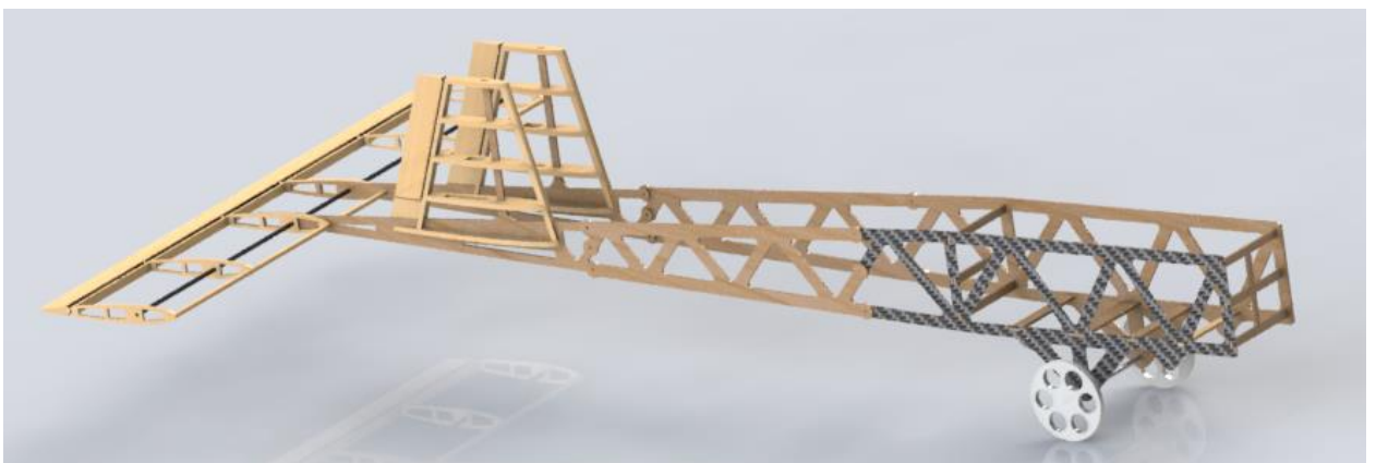
Figura 44. Vista do tail-boom com fixação na fuselagem e empenagem, referente a 2017.
