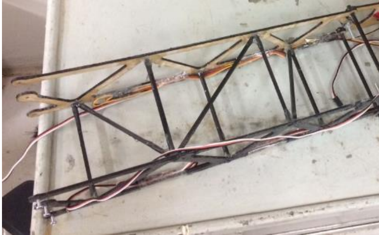
Figura 45. Tail-boom após adaptações feitas durante a construção.
