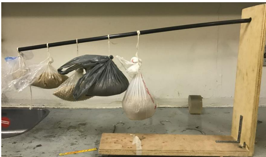
Figura 48. Teste de flexão da longarina.
