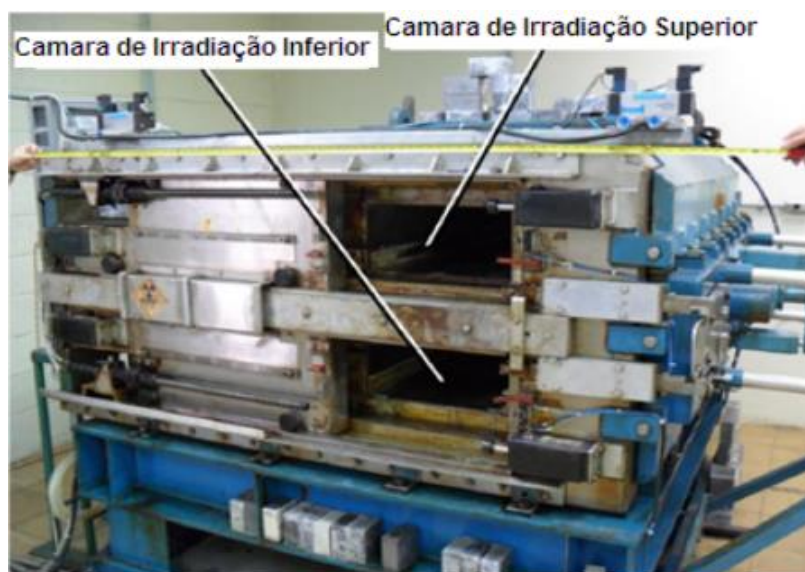
FIG. 2.7: Vista frontal do irradiador gama de pesquisa do CTE x com as portas abertas. (FONTE: RUSIN, 2012).
