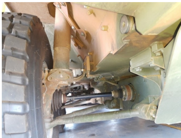
Figura 19 – Suspensão MacPherson dianteira direita da VBTP-MR Guarani
