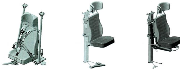
FIG 18: Diferentes modelos de assento do veículo GUARANI (Manual Técnico IVECO, 2012)
