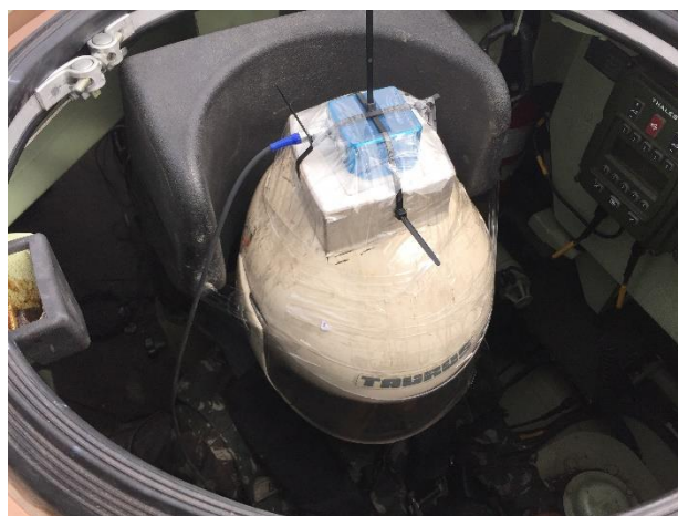
FIG 58: Localização da IMU no capacete do motorista
