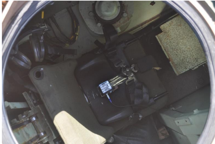
FIG 56: Localização da IMU no assento do Motorista
