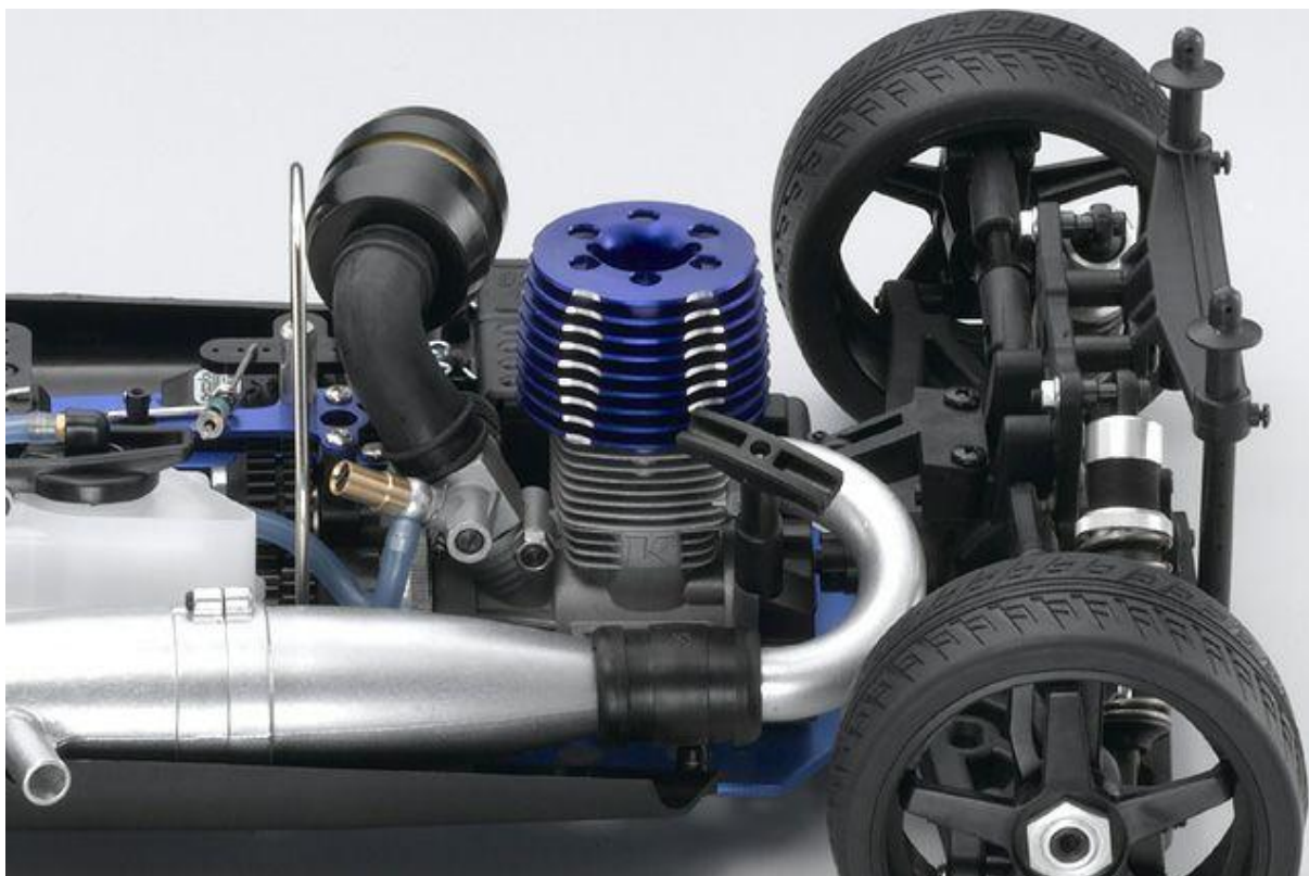
FIG 2.2: Detalhes do motor a combustão interna original do automodelo Inferno GT2.
