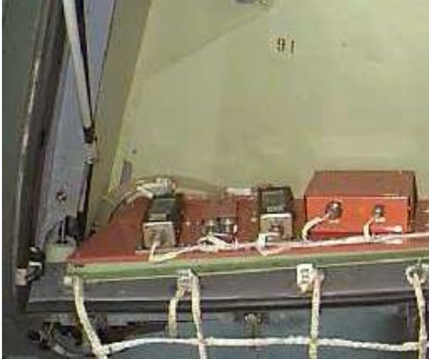
Figura 3.5: Transdutores de pressão no Bagageiro (cortesia IPEV)
