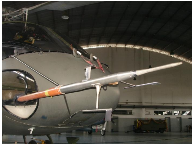
Figura 2.3: boom anemométrico (fonte: IPEV, 2009)
