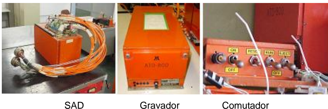
Figura 3.3: Instrumentação da Aeronave Ensaída (cortesia GEEV)
