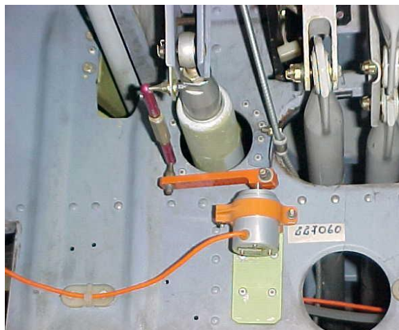
Figura 3.6: Instrumentação dos Comandos de Vôo Transdutores Potenciométricos (cortesia IPEV)
