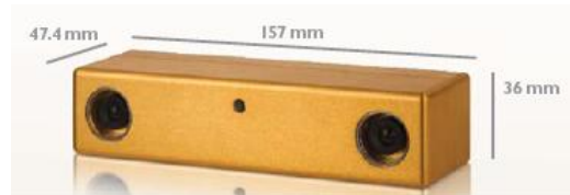
Figura 1.3: Sensor visual estereoscópico [53].
