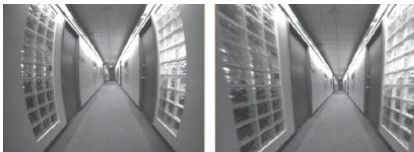
Figura 5.5: Imagem da câmera distorcida (esquerda) e corrigida (direita) [53].
