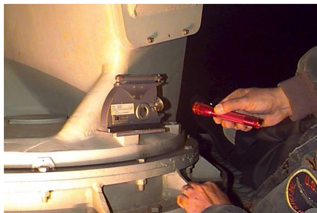
FIG. 2.8 Clinômetro posicionado em trilho na plataforma de um radar para realização de Tilt Test .
