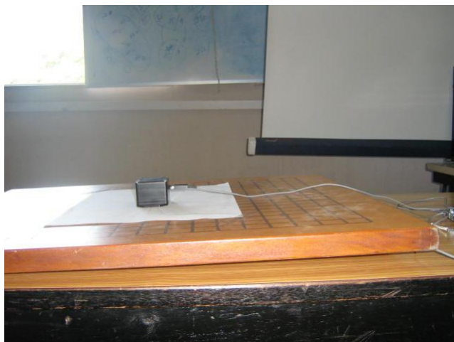
FIG. 4.20 Sensor 3DM-GX2 posicionado em cima da base de madeira com inclinação I.
