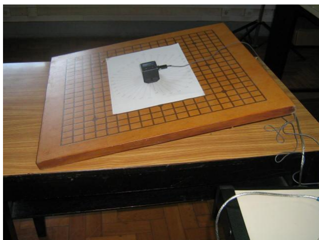
FIG. 4.21 Sensor 3DM-GX2 posicionado em cima da base de madeira com inclinação II.
