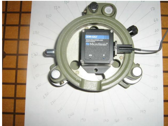
FIG. 4.18 Sensor 3DM-GX2 posicionado em cima da base niveladora.
