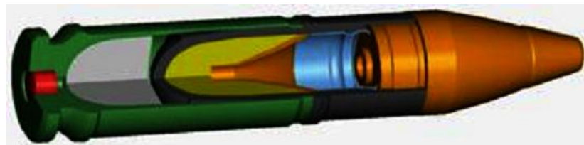
FIG 2-11 – Desenho em corte de uma munição com carga oca - BF2 – 2000
