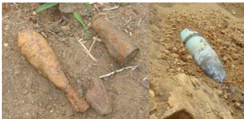
FIG 2-18 – Munições destruídas de maneira incompleta(Elaboração própria)
