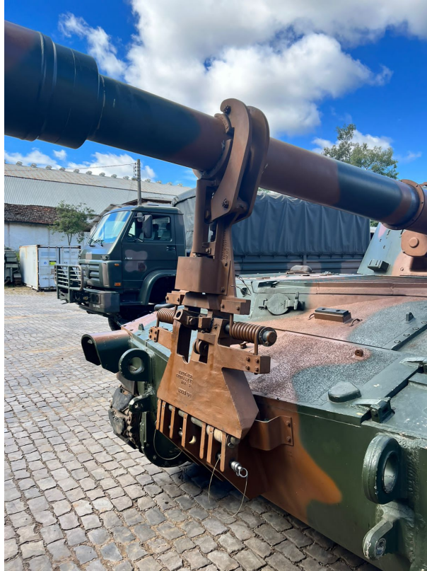
Figura 3 – Sistema de travamento automático do tubo de uma viatura M109A5+.
