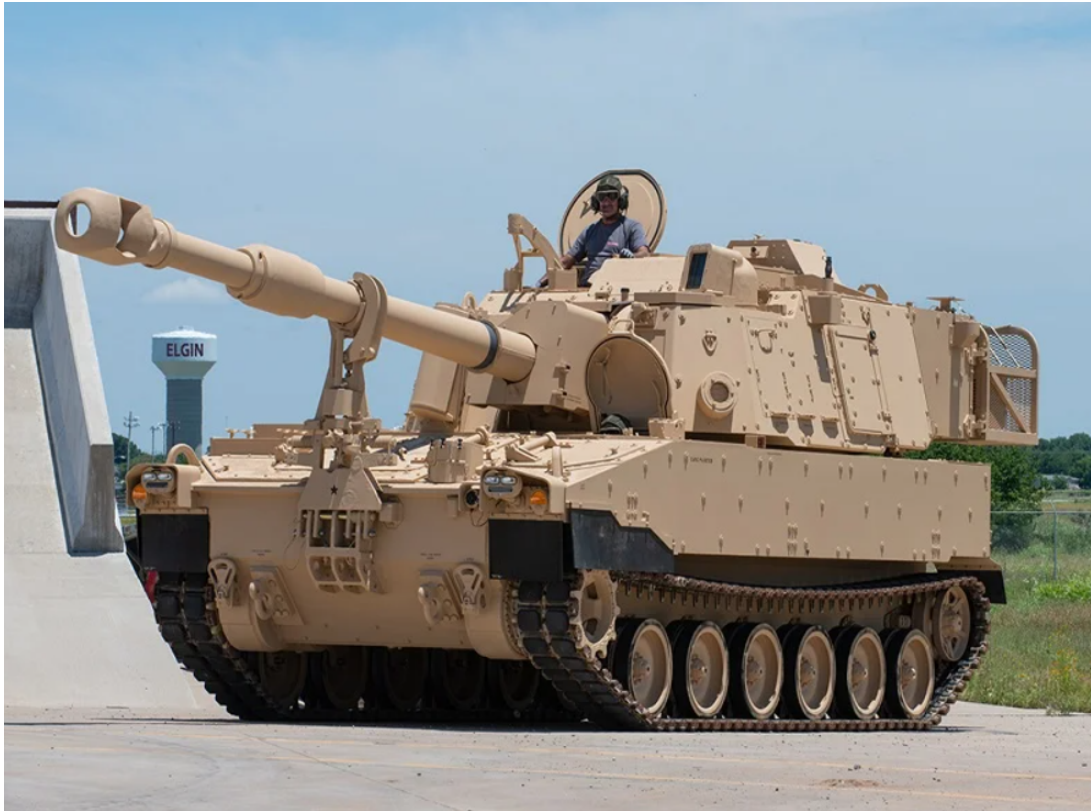
Figura 1 – Obuseiro Autopropulsado da versão M109A7, também conhecido como Paladin, (ARMY/TECHNOLOGY, 2022).
