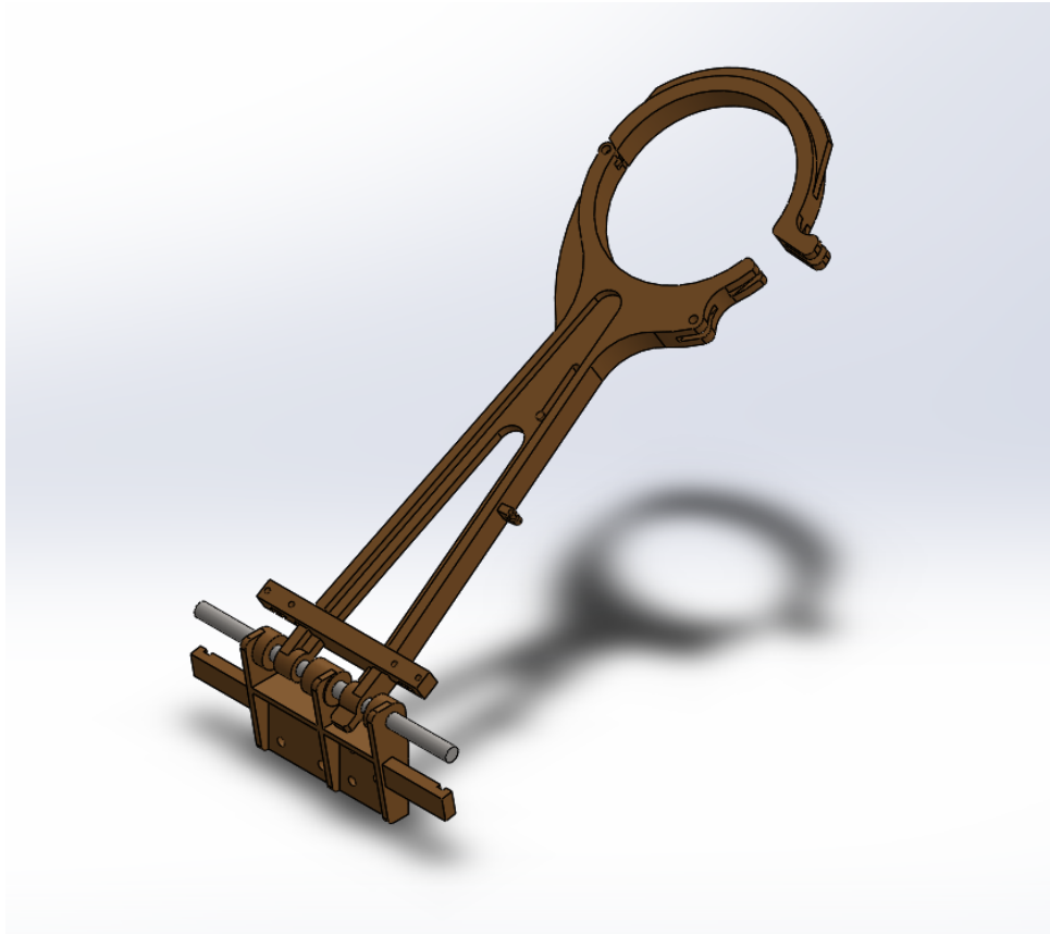
Figura 7 – Modelo feito em CAD da garra.
