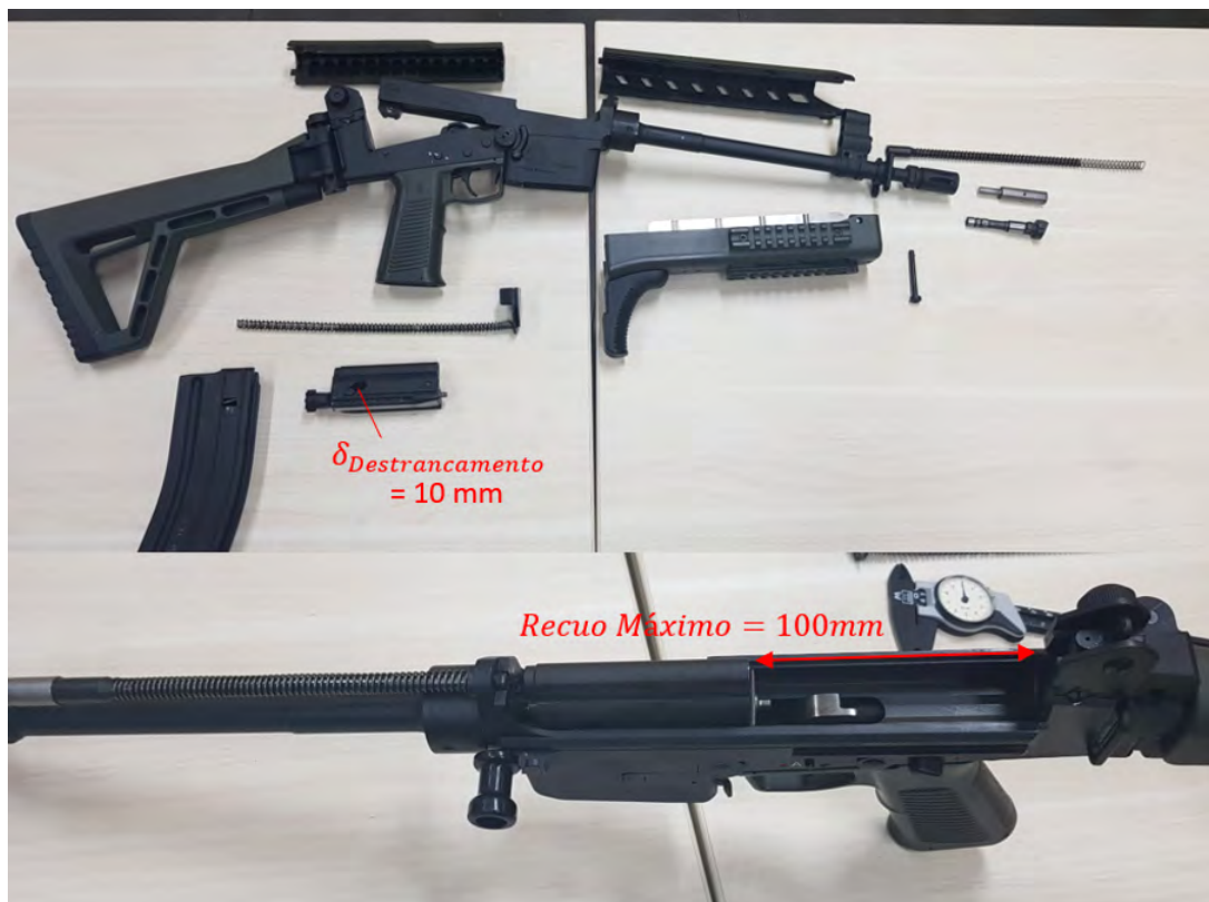
Figura 76 – Desmontagem em 1º Escalo e recuo mximo (Autoria Prpria)
