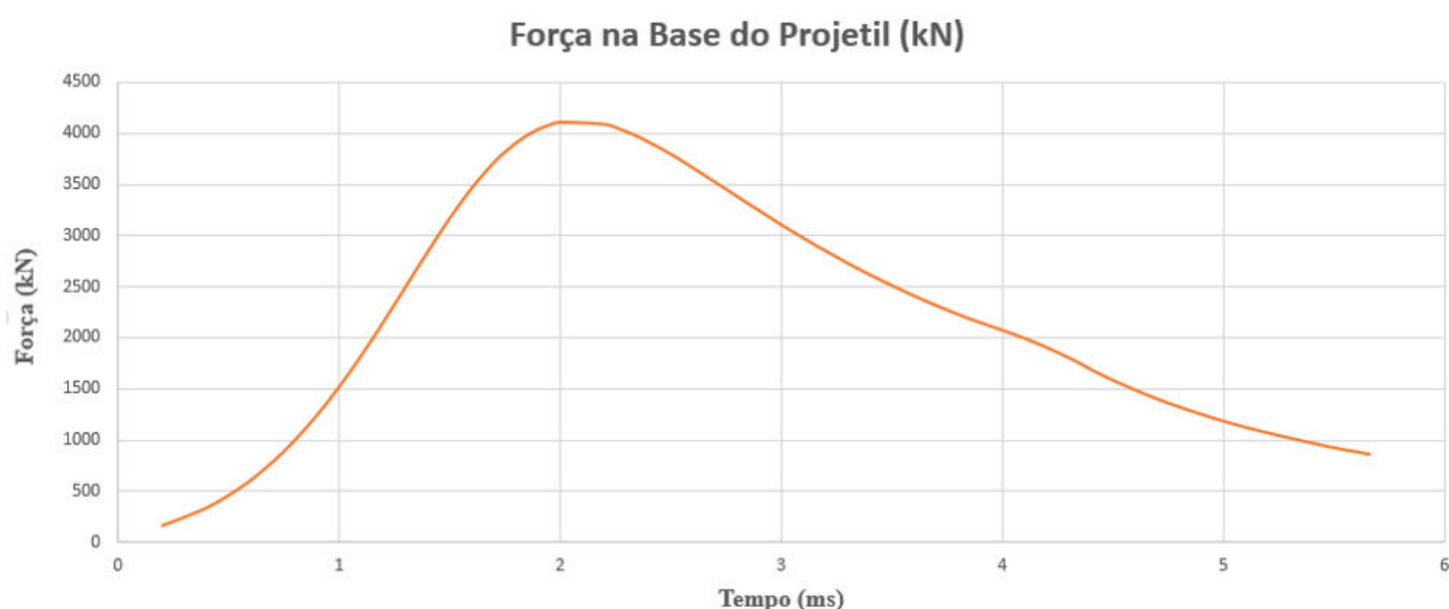
FIG. 3.9: Curva da força exercida pelos gases propelentes sobre a base do projétil em função do tempo.
