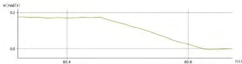
Figura 39 – Resposta a uma entrada degrau de velocidade angular
