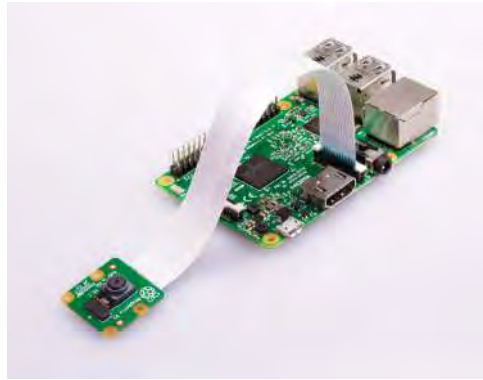
Figura 64 – Montagem da câmera no microcomputador
