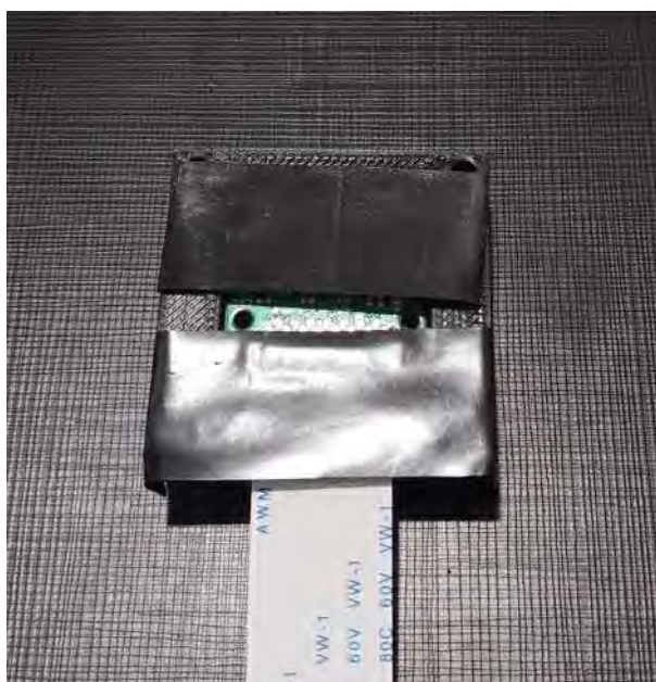
Figura 67 – Parte da frente da proteção montada na câmera
