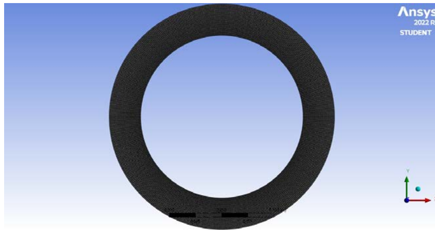
Figura 6 – Malha do Tubo do Obuseiro 155mm.
