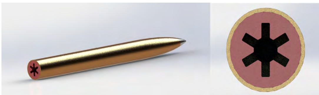
Figura 28 – Vista do propelente em modelagem tridimensional do foguete SS-09 TS.
