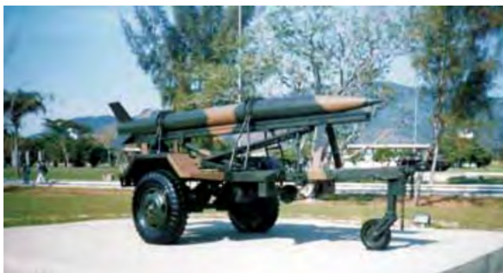
Figura 7 – O X-40 sobre um reparo auto rebocado montado sobre uma carreta Sanvas.
