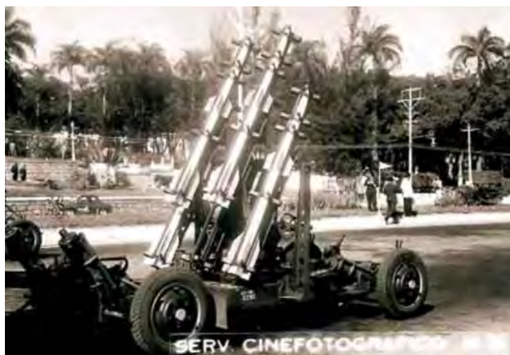
Figura 3 – Lançador de foguete F-114-DE com cinco foguetes, montado sobre reparo Bofors 40/60 em desfile militar de 28 de junho de 1966.
