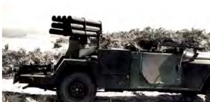
Figura 2 – Fv-108-R com dez tubos montado sobre veículo 4x4 Jeep Willys Overland \frac{3}{4} ton.
