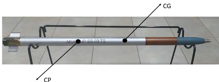
Figura 15 – Ilustração do centro de gravidade (CG) e do centro de pressão (CP) do foguete SS-09 TS.
