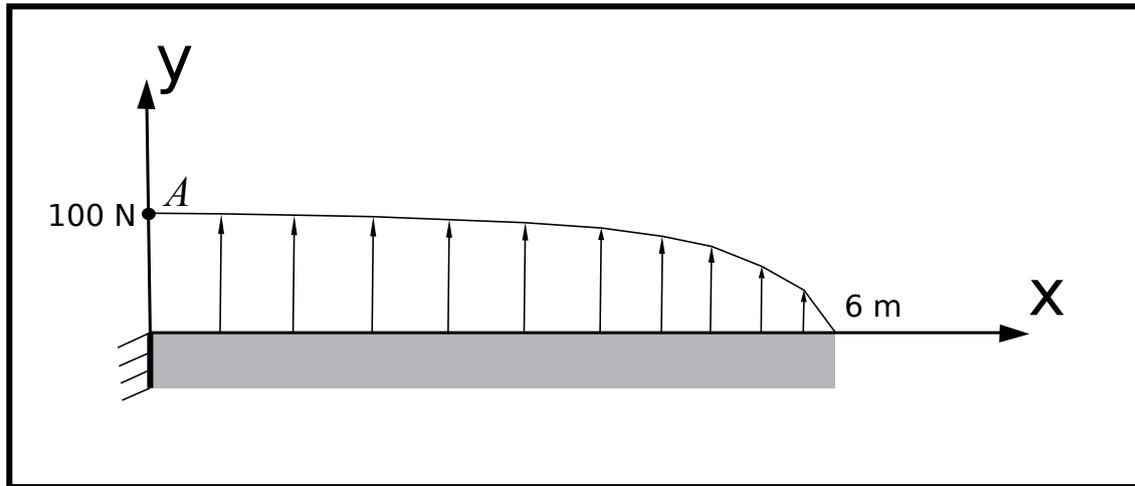
Considere uma asa de 6 m de comprimento, conforme figura acima. Esta asa possui um carregamento de sustentação com distribuição parabólica, sendo o ponto  $A$  o ponto de máximo da parábola.
