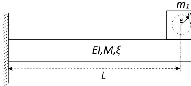
Um helicóptero está com seu rotor de cauda desbalanceado. A massa de desbalanceamento  $m$  posicionada a uma distância  $e$  do centro do eixo de rotação, conforme figura. A seção do rotor de cauda mostrada na figura tem comprimento  $L$ , massa  $M$ , rigidez à flexão  $EI$  e uma razão de amortecimento  $\xi$ . Considere que a massa das pás do rotor de cauda, incluindo o sistema de transmissão, é  $m_1$ . A frequência de rotação do rotor de cauda é  $\Omega$ .
