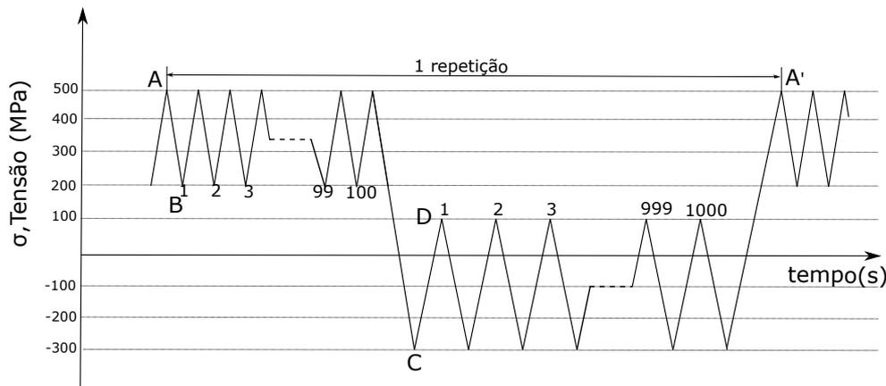
No gráfico acima encontra-se ilustrada a variação do carregamento a que um componente instalado em um helicóptero está submetido durante a execução de uma manobra que envolve a fase de pairado e de voo à frente. A partir dela, com base nas tensões máximas  $\sigma_{max}$ , tensões mínimas  $\sigma_{min}$  e amplitudes de tensão  $\sigma_a$ , é possível determinar a vida em fadiga de um componente.
