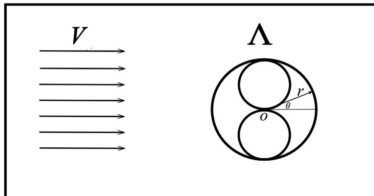
Considere um escoamento potencial bidimensional, formado por um escoamento uniforme de velocidade  $V$  e um dipolo de intensidade  $\Lambda$ .
