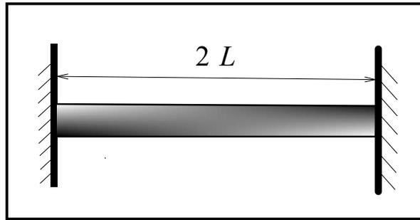
A figura acima representa uma viga engastada entre duas cavernas de uma aeronave. Esta viga é uma estrutura, que receberá uma bomba hidráulica em sua região central. Considere a massa da bomba irrelevante, bem como o vínculo da viga com as cavernas uma condição de engaste.
