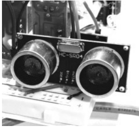
Foto do módulo HC-SR04 (emissor ultrassom e detector de eco).
