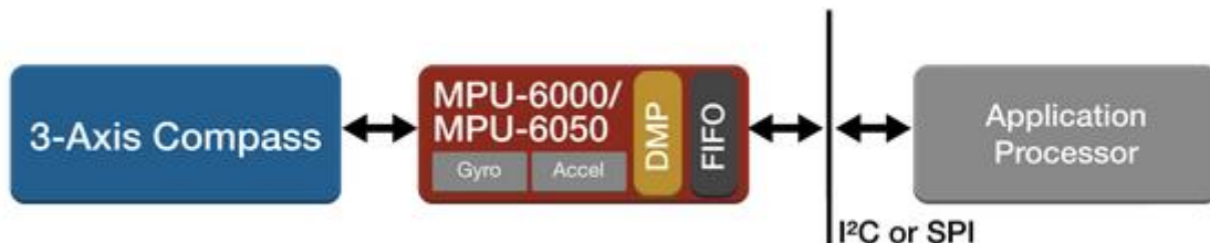
Figura 4.9 – Diagrama do Sistema MPU-6000/6050™
