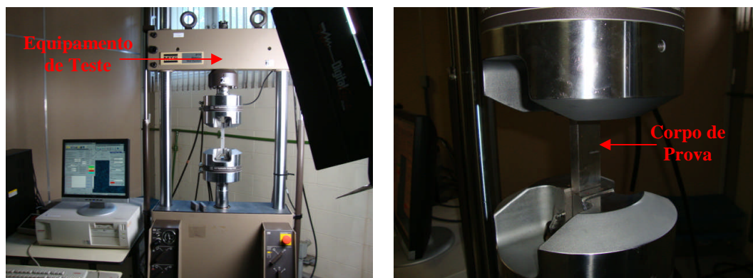
FIG. 3.8 – Nucleação da pré-trinca de fadiga nos corpos de prova SENT
