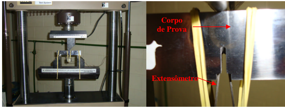
FIG. 4.1 – Realização do ensaio de fadiga no corpo de prova SE(B)
