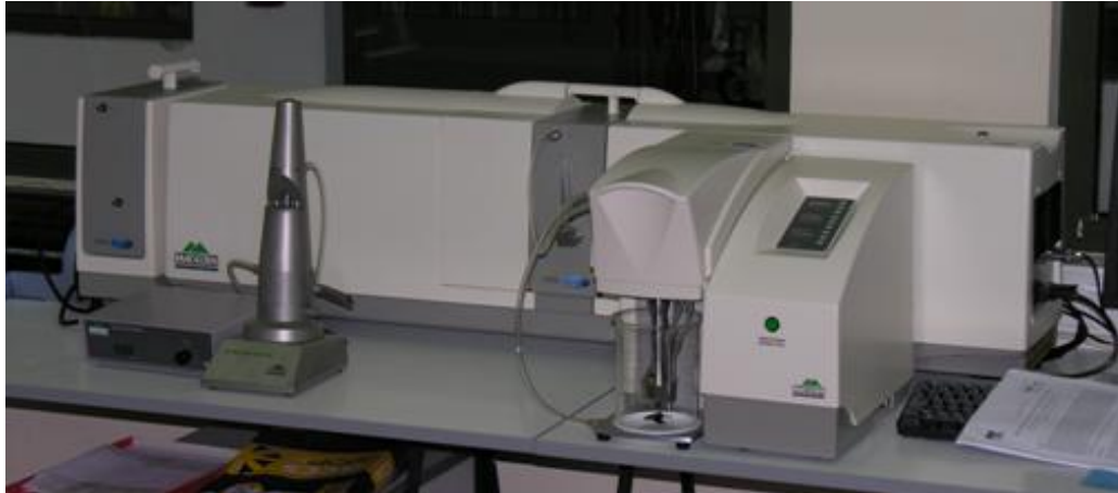
FIG. 3.2 Analisador Malvern modelo 3600 Ec ( www.malvern.com )
