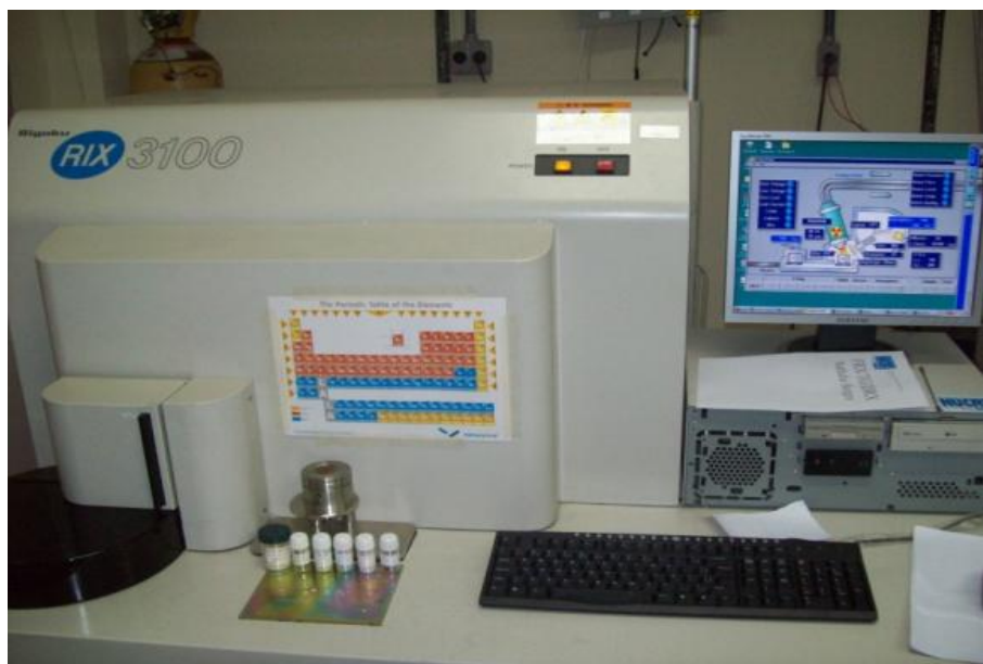
FIG. 3.1 Espectrômetro de Fluorescência de Raio-X Modelo: Rigaku RIX 3100Tubo de Ródio
