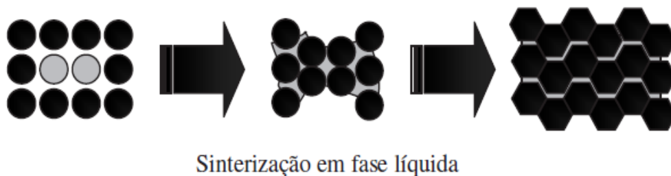
FIG. 2.14 Sinterização em fase líquida ( Adaptado de LIMA, 2006)
