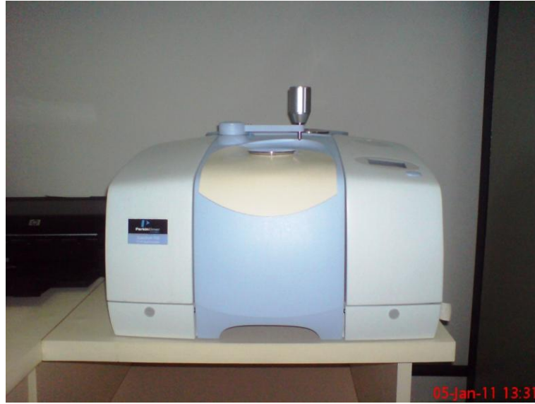
FIG. 3.8 Espectrômetro de infravermelho marca PERKIN-ELMER modelo SPECTRUM 100.
