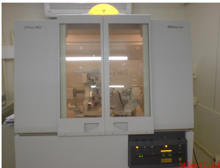
FIG. 3.3 Difratômetro de raios X marca PANALYTICAL modelos X'PERT PRO MPD.
