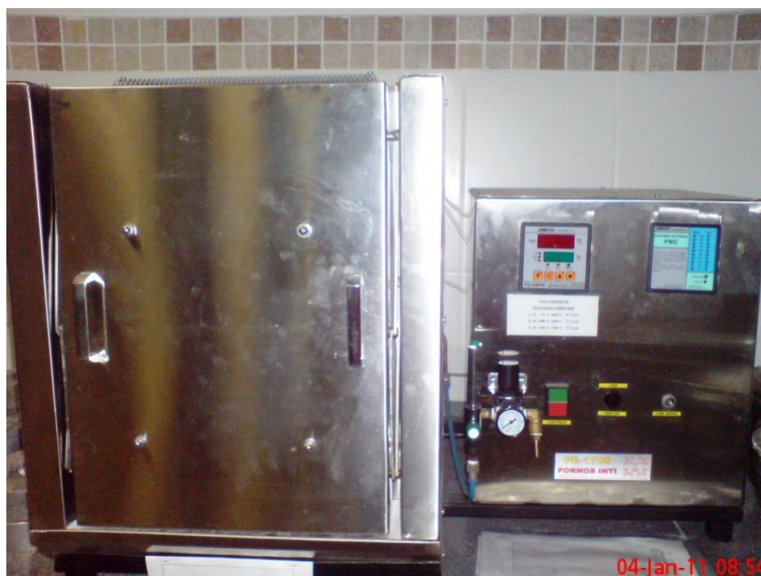
FIG. 3.1 Forno utilizado marca INTI modelo FE-1700, temperatura máxima 1700°C.
