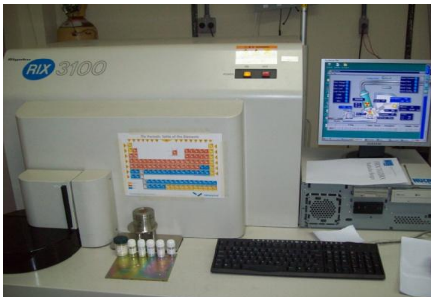
FIG. 3.5 Espectrômetro de fluorescência de raios X marca RIGAKU modelo RIX 3100.
