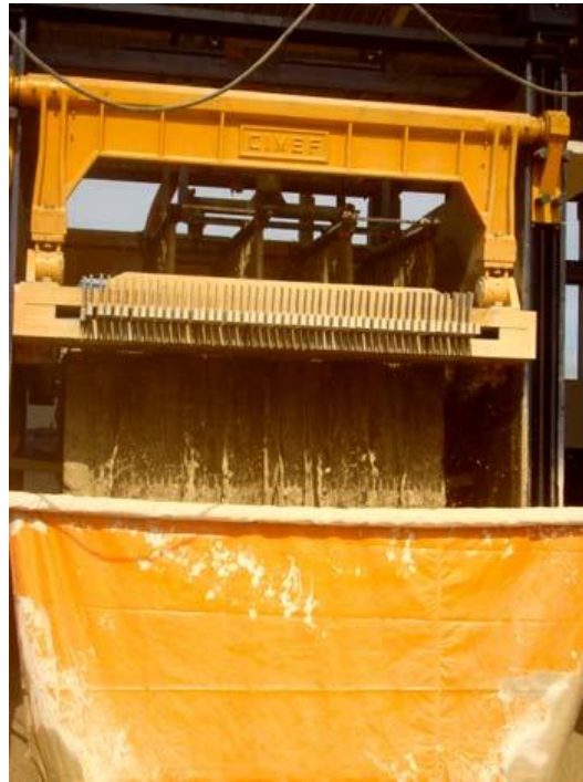
FIG. 2.1 Tear para corte de chapas (VSB PISO DE GRANITO, 2010).
