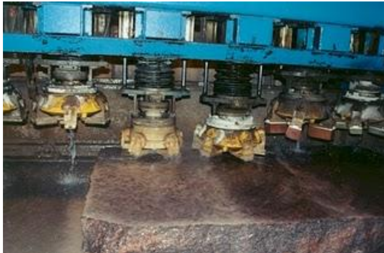
FIG. 2.4 Máquina para levigamento (POLIDOR MB, 2010).
