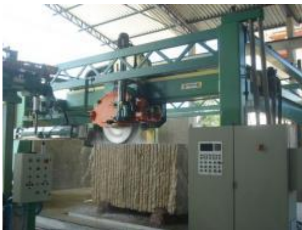
FIG. 2.2 Talha-blocos ( GRANITOS AM, 2010).
