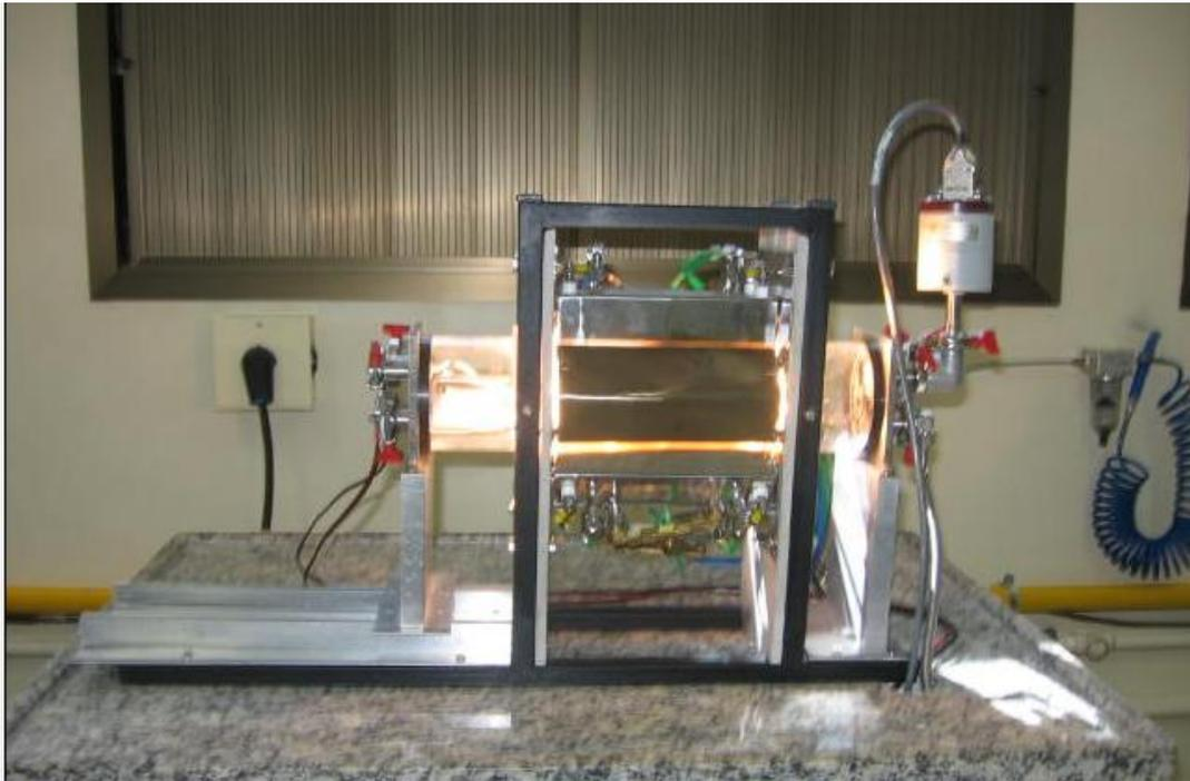
**FIG. 5.1 Sistema CSS utilizado nas deposições e nos tratamentos térmicos das amostras.**
