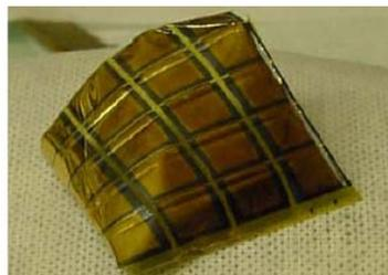
FIG.2.12 Mini-módulo de CdTe sobre poliimida (ROMEO et al., 2003).
