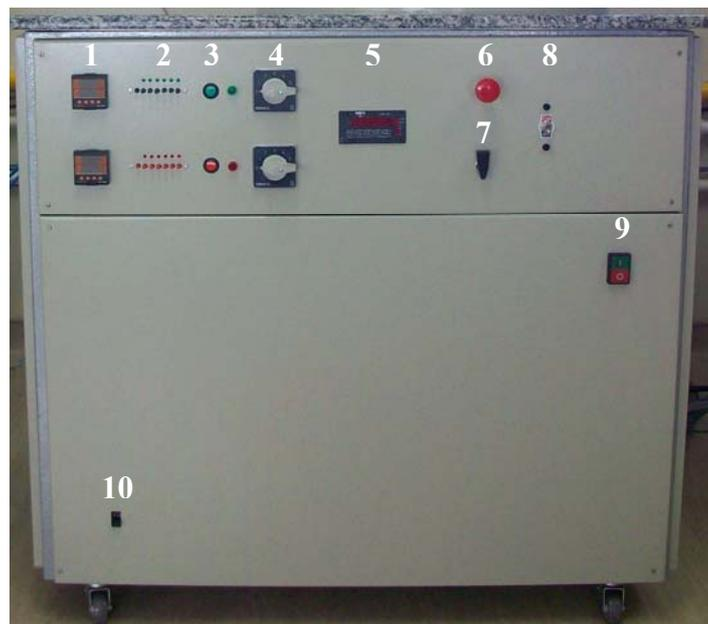
FIG.3.10 Painel frontal montado com dois controladores/programadores (1) e chaves seletoras do termopar (2) e chaves comutadoras do aquecedor (4). Podem-se observar também os interruptores de alimentação dos aquecedores (3), o mostrador de pressão (5), a válvula de entrada de gás do sistema e de purga (6), a válvula de admissão de ar atmosférico (7), a chave da válvula pneumática para selamento do sistema (8), a chave da bomba (9) e, por fim, a chave geral (10).
