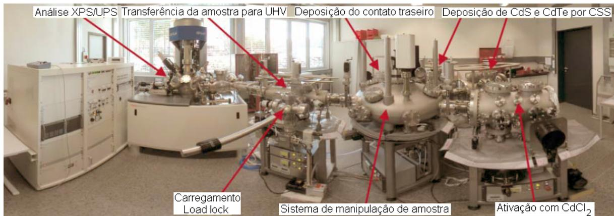
FIG.1.8 Sistema DAISY-SOL (Darmstadt Integrated System for Solar energy research): o substrato de vidro/ITO/SnO<sub>2</sub> é inserido para dentro do sistema de vácuo através da câmara de carregamento e, a seguir, são realizadas as deposições por CSS de CdS e CdTe, a ativação por CdCl<sub>2</sub> e a formação do contato traseiro, em câmaras separadas, conectadas a um sistema de manipulação de amostra (FRITSCHÉ et al., 2005; SPÄTH et al., 2004).
