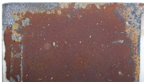
FIG. 4.8 Fotografia da placa-fonte de CdTe após 15 deposições na presença de O<sub>2</sub>.
