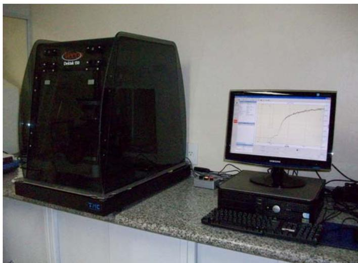
FIG.3.12 Perfilômetro Dektak 150, da Veeco, utilizado para medição de espessura dos filmes.
