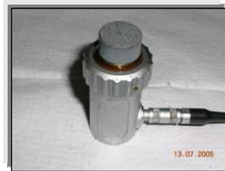
FIG. 3.12 Amostra posicionada sobre o transdutor
