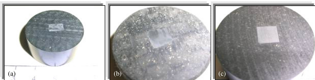
FIG. 3.13 Superfície após retífica em equipamentos diferentes (a) CTA, (b) AGRJ, (c) IME
