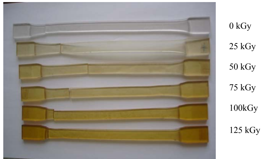
FIG. 4.9 – Corpos de prova típicos dos ensaios de tração, após a ruptura
