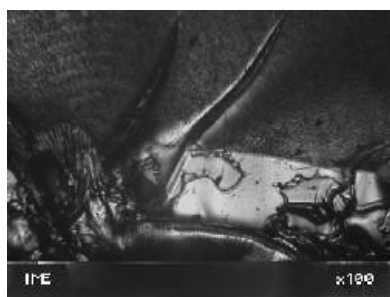
(c) A região lisa mais clara corresponde à região elíptica, onde se inicia o microfissuramento (MO)
