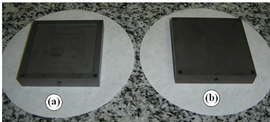
FIG. 3.9: Blocos de grafite utilizados como suporte para a fonte e para o substrato: (a) base; (b) tampa.
