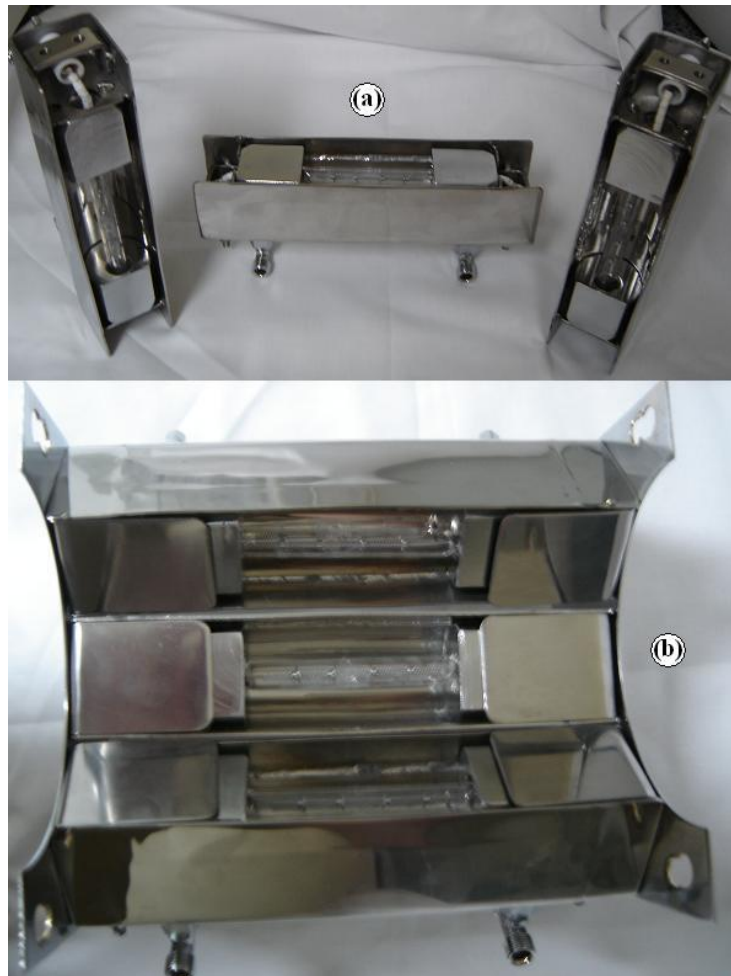
FIG. 3.7: Aquecedores novos: (a) aquecedores individuais antes de serem montados; (b) aquecedor inferior (com 3 lâmpadas), pronto para ser montado no sistema.
