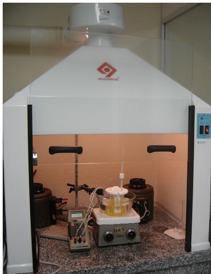
FIG. 3.3: Visão geral do sistema de deposição por CBD. Destaque para a capela onde é realizado o processo de deposição.
