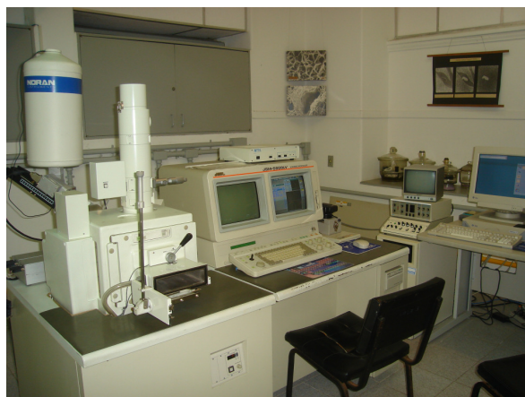
Figura 8 - Microscópio eletrônico JEOL, modelo JSM T 330 A, acoplado com EDS , utilizado na caracterização da superfície.
