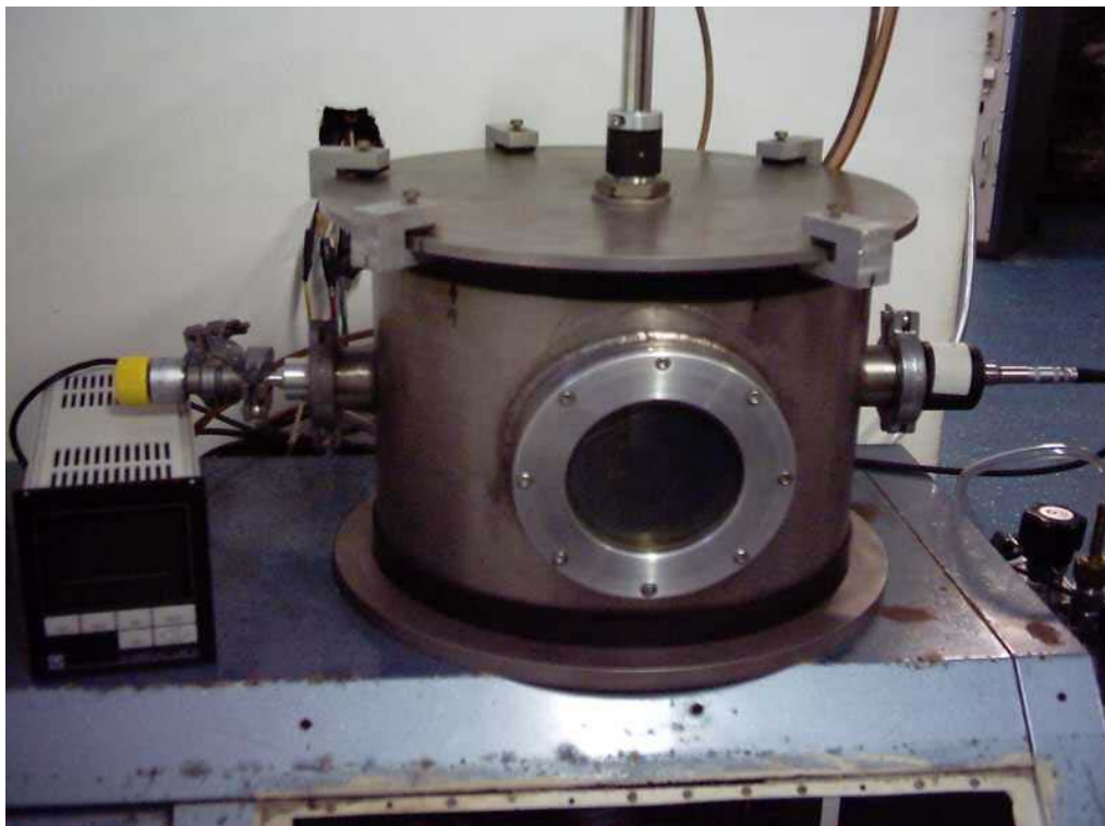
FIG. 3.2 Equipamento para deposição por pulverização catódica assistida por campo magnético constante do Laboratório de Filmes Finos do IME.
