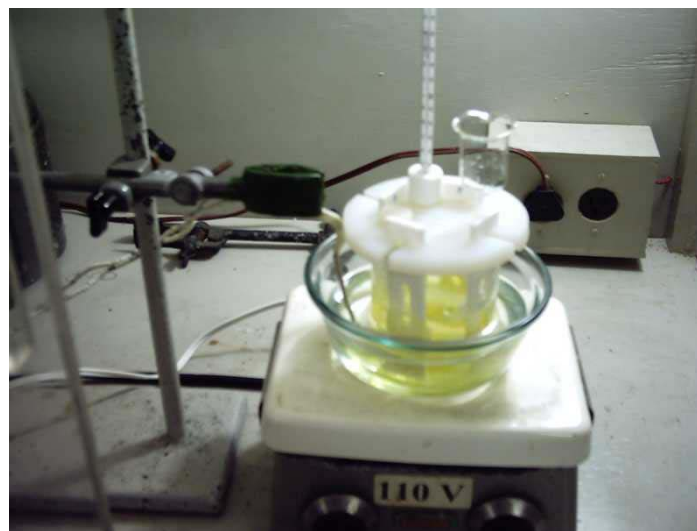
FIG. 3.3 Aparato experimental montado no Laboratório de Filmes Finos do IME para deposição de filmes de CdS por CBD (a) esquema e (b) foto durante deposição.
