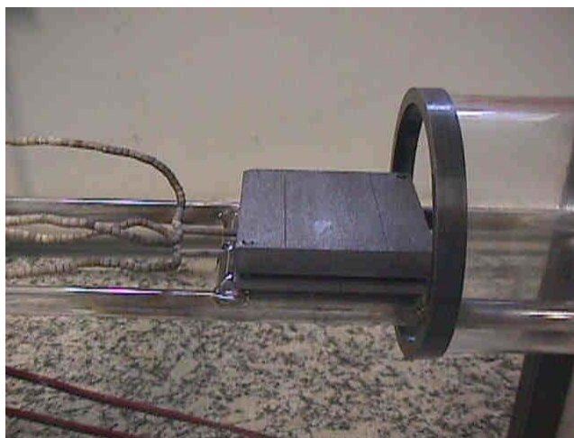
FIG 3.6 Blocos de grafite da fonte e do substrato, juntamente com os espaçadores de quartzo, na configuração pronta para recozimento.
