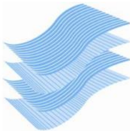
FIG.2.15 - ilustração com 4 camadas de fibras alinhadas dispostas a 0^\circ/90^\circ/0^\circ/90^\circ
