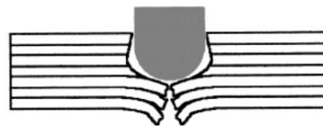
FIG.2.29- Representação do mecanismo de dano por cisalhamento ou “Shear Plug” ELLIS et al., 1998
