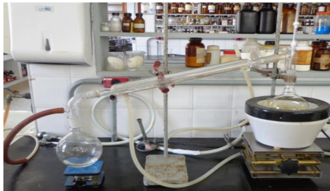
FIG.3.7 – Fotografia do equipamento utilizado na destilação do decahidronaftaleno.
