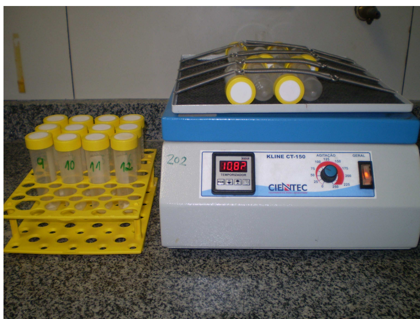
FIG. 3.2 Tubos contendo soluções de HA imersas em BSA e controles contendo Milli-Q® sob agitação.
