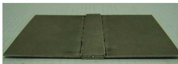
FIG. 4.7: Foto das chapas após soldagem. As chapas foram usadas para o corte dos corpos-de-provas de ensaio de tração e de cisalhamento.
