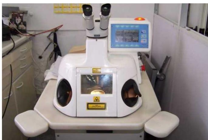
FIG. 4.1: Equipamento de soldagem a laser Nd:YAG utilizado.
