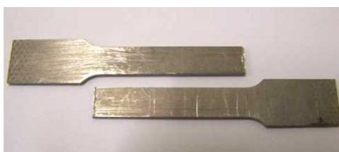
FIG. 5.2: Foto do cp fraturado evidenciando a fratura no cordão de solda.
