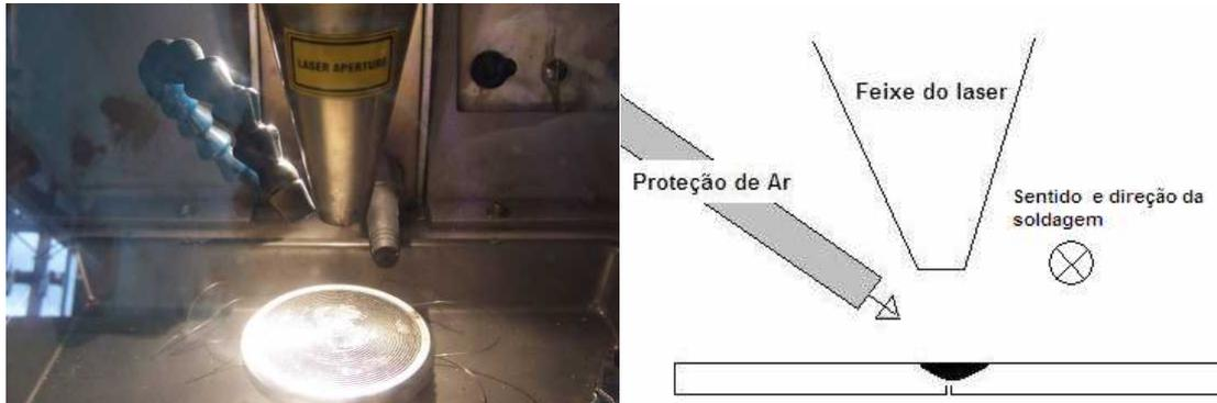
FIG. 4.2 a) Detalhe do interior da máquina de soldagem laser Dentaurum DL 2000 2S e b) Desenho esquemático do posicionamento do feixe, vazão do gás de proteção e chapa soldada.
