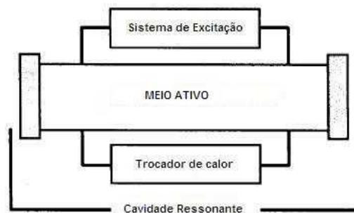
FIG. 2.1 Principais componentes que constituem os sistemas a laser. (AWS C7.2 : 1998)
