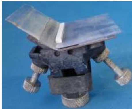
FIG. 3. 4 Dispositivo empregado para fazer o chanfro das arestas dos corpos- de-prova de flexão (SANTOS, 2012).
