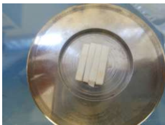
FIG. 3. 10 Disposição dos corpos-de-prova para a difratometria
