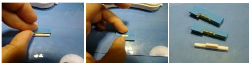
FIG. 3. 8 Produção do corpo-de-prova com cobertura de porcelana
