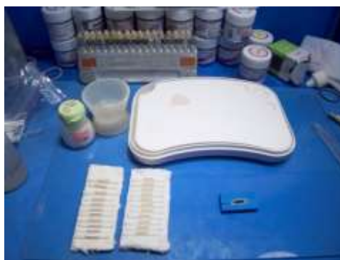
FIG. 3. 9 Corpos-de-prova com cobertura de cerâmica feldspática após a sinterização
