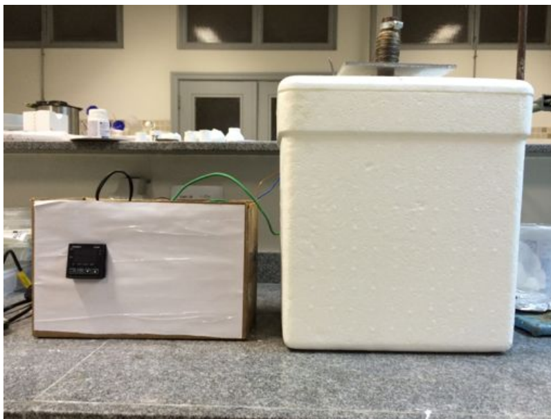
FIG. 3.6 Equipamento de "freeze casting" montado no IME
