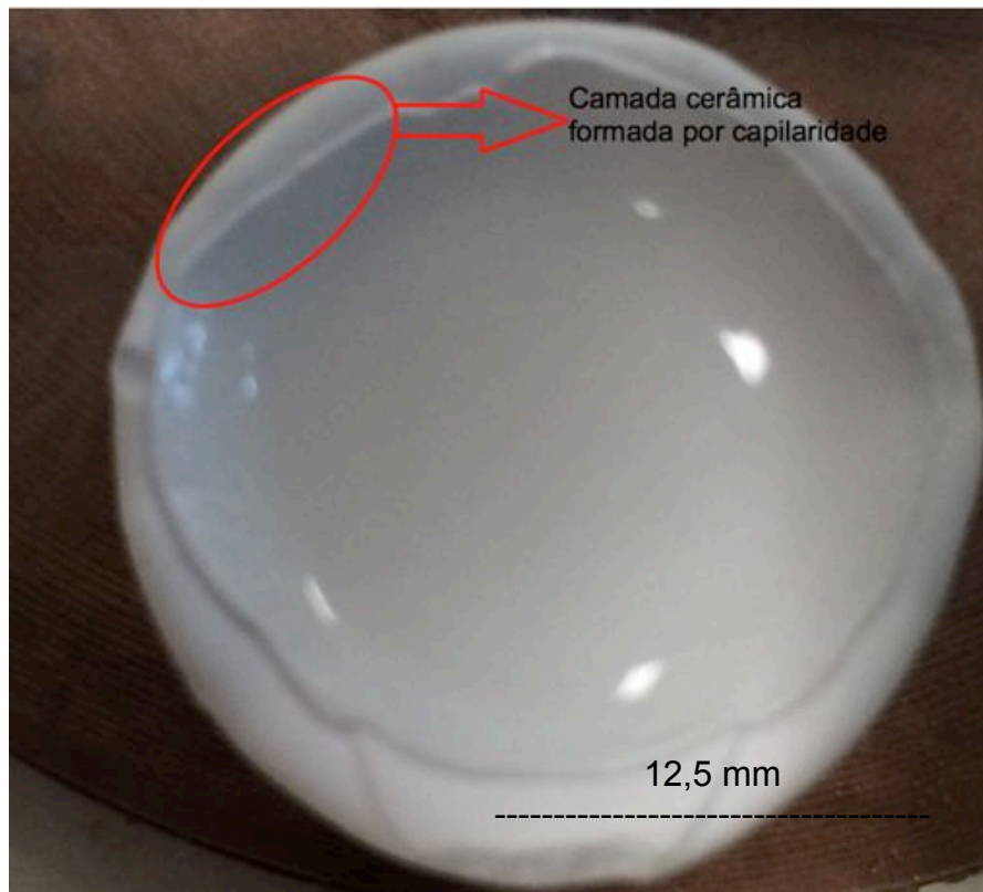
FIG. 3.4 Detalhe da camada cerâmica formada por capilaridade
