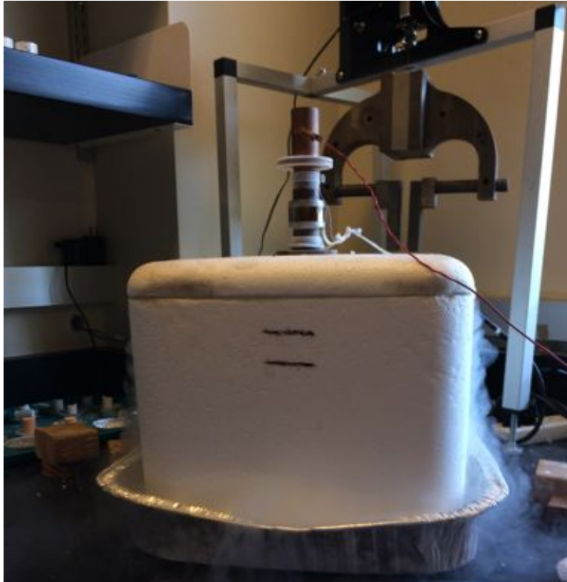
FIG. 3.5 Equipamento de "freeze casting" da UCSD com uma única amostra
