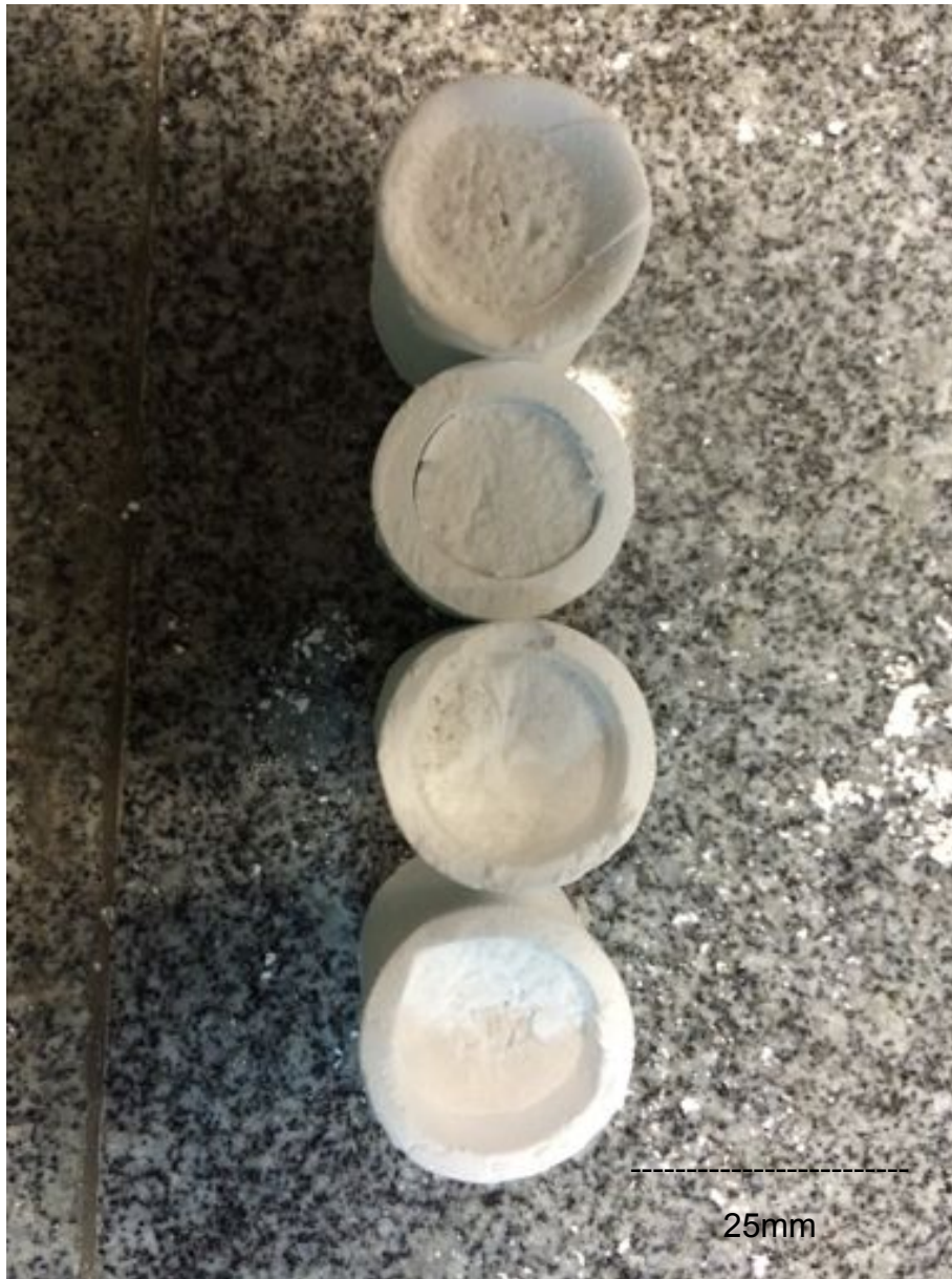
FIG. 4.22 Cerâmicos produzidos com adesão na interface.
