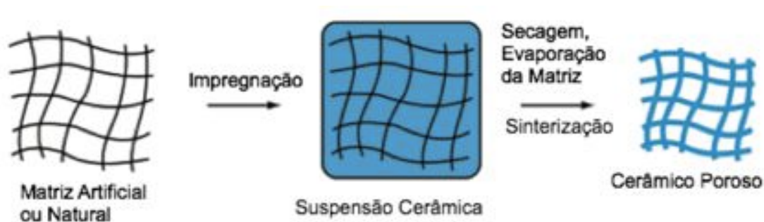
FIG. 2.2 Ilustração esquemática do método de réplica usado na fabricação de cerâmicos porosos (adaptado de STUDART, 2006)
