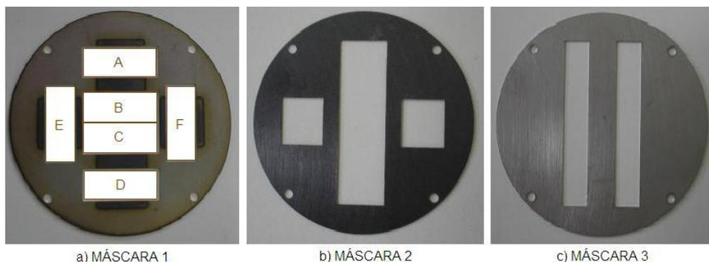
FIG. 3.13 Máscaras utilizadas nas deposições: a) Máscara 1- mantém os seis substratos fixos nas posições (A, B, C, D, E, F); b) Máscara 2 – usada nas deposições de  $\text{VO}_x$ ; c) Máscara 3 – usada nas deposições dos contatos elétricos. [CASTRO, 2008].
