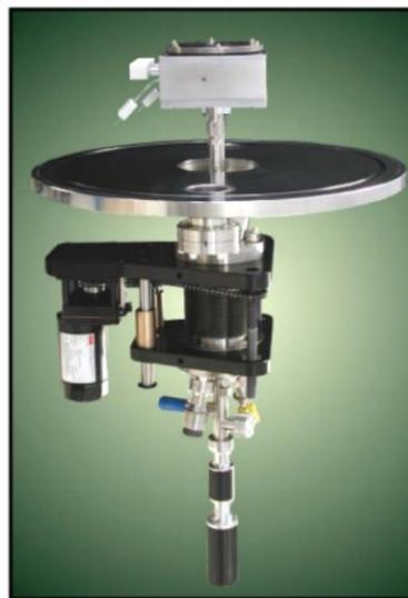
FIG. 3.5 Base porta-substrato com aquecedor e controle de velocidade de rotação.
