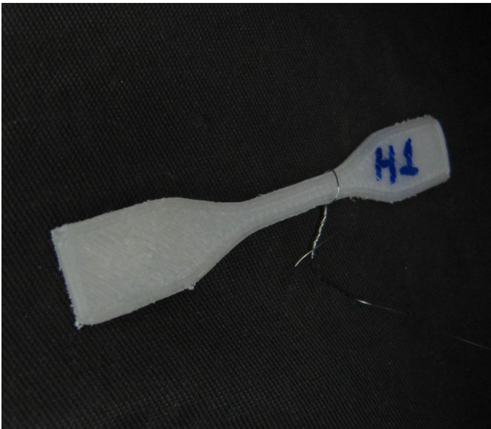
Figura 35 – Corpo de prova após a impressão 3D com rebarba de material devido a inconsistência no diâmetro do filamento.
