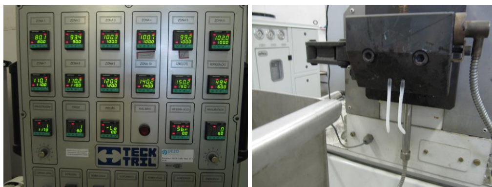
Figura 22 – Painel da extrusora mostrando as temperaturas nas zonas (lado esquerdo) e a matriz com perfil circular (lado direito)
