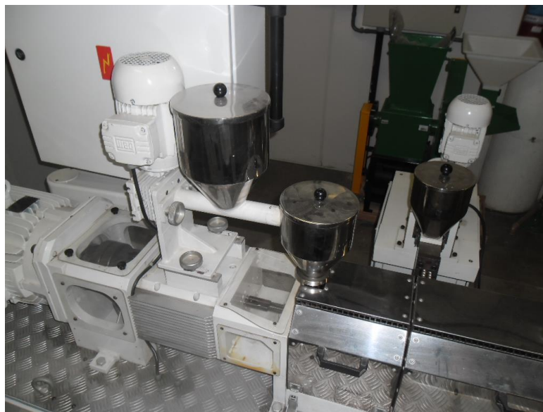
Figura 21 - Extrusora Dupla Rosca Teck Trill co-rotatória L/D 40 1
