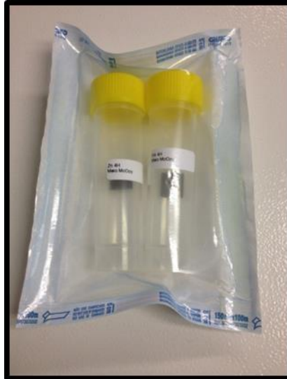
FIG. 3.15 Placas de titânio recobertas por 4h com e sem Zn, antes e após conversão
