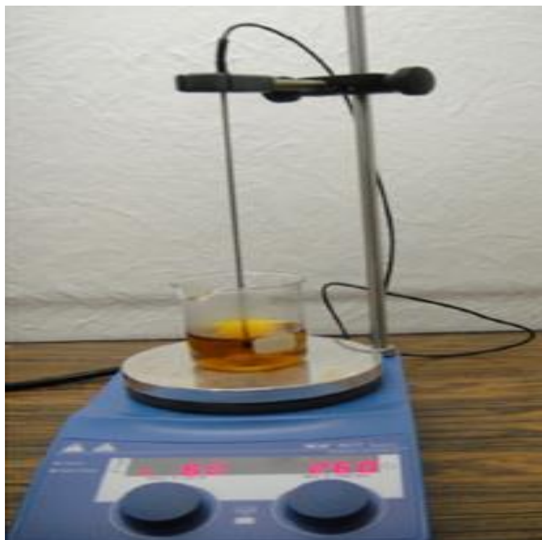
FIG. 3.2: Solução final sendo aquecida na placa quente (CARVALHO, 2012).
