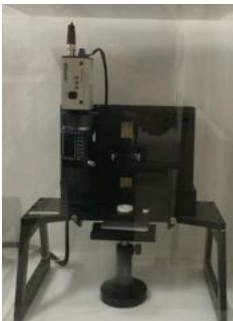
FIG. 4.4: Goniômetro FTA 100 (First Ten Angstroms).
