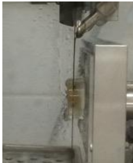
FIG. 4.9: Corte da amostra implante-osso para obter um fragmento de aproximadamente 200 \mu\text{m} colado na lâmina.
