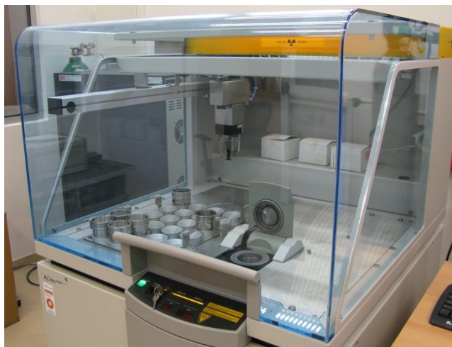
FIG. 4.2: Modelo Axios mAX da Panalytical utilizado para análise por fluorescência de raios-x.
