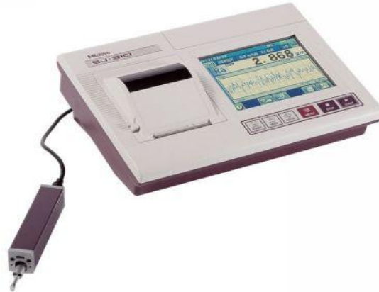
FIG. 4.3: Rugosímetro de contato Mitutoyo SJ 201P.
