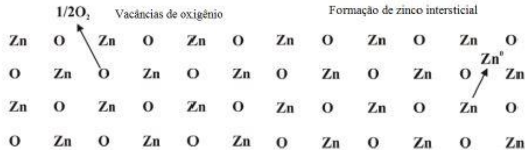
FIG. 2.2 Esquema da formação de vacâncias de oxigênio e Zn intersticiais.
