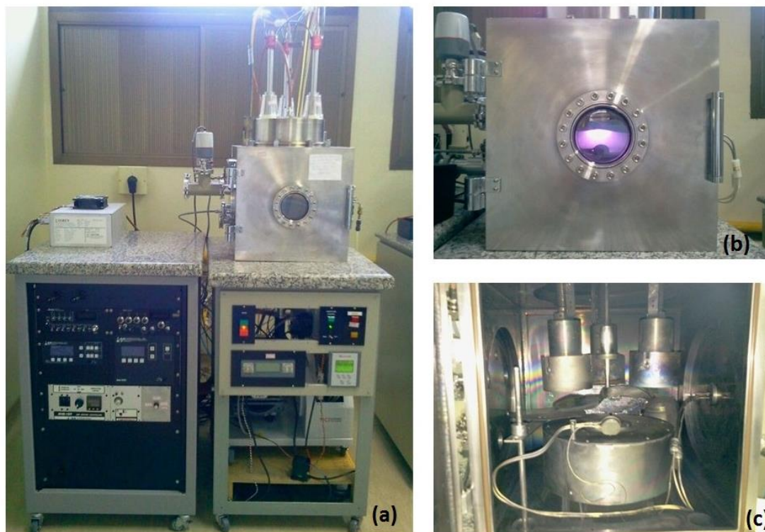
FIG. 3.1 (a) Equipamento de deposição por pulverização catódica; (b) Campânula cúbica em aço inoxidável 304; (c) Catodos dentro da campânula.
