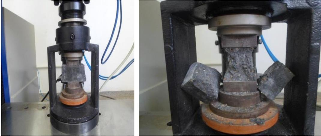
FIG. 5.15 Prensa utilizada para ruptura das argamassas submetidas à compressão.
