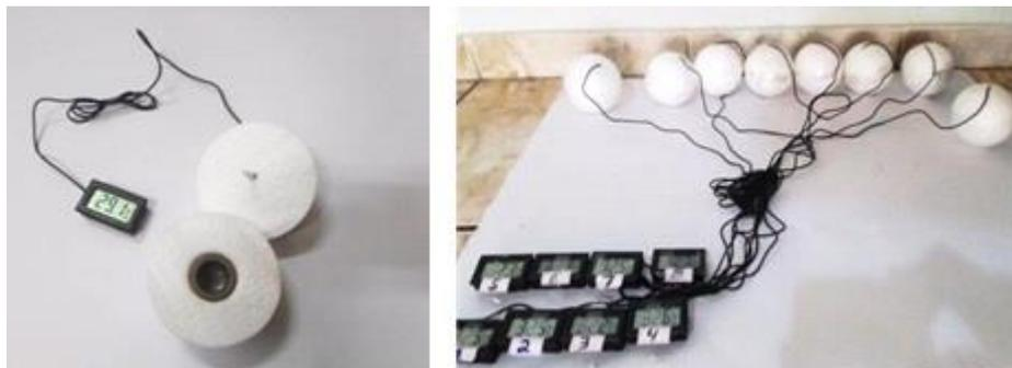
FIG. 5.10 Esquema de utilização do artefato de isopor para o isolamento térmico da pasta de cimento.
