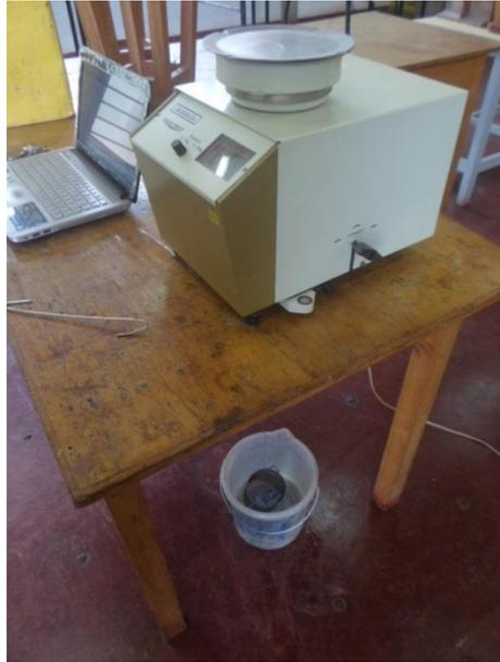
FIG. 5.7 Balança hidrostática para pesagem das argamassas.
