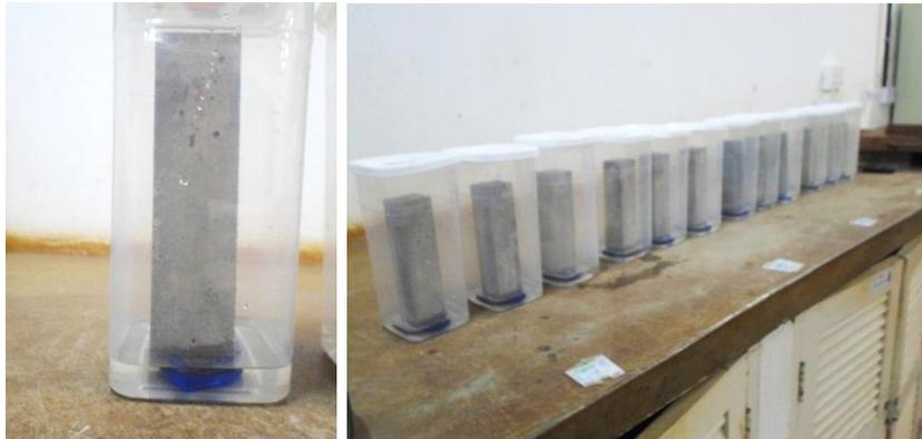
FIG. 5.8 Corpos-de-prova submetidos ao ensaio de absorção por meio da capilaridade.
