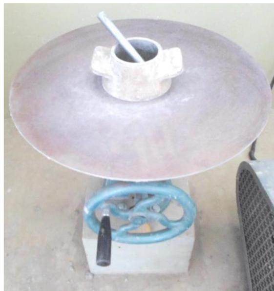
FIG. 5.6 Mesa de consistência para argamassas.
