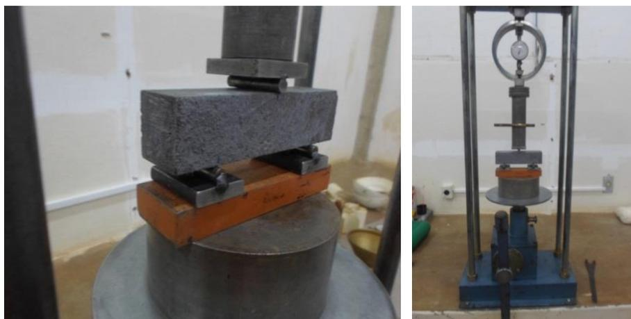
FIG. 5.14 Prensa CBR utilizada para ruptura das argamassas submetidas à tração na flexão.
