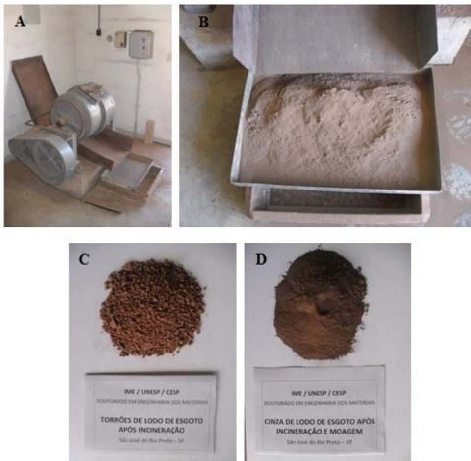
FIG. 5.1 A) Moinho de bolas de aço. B) CLE moída com 50 minutos. C) CLE após queima. D) CLE moída.
