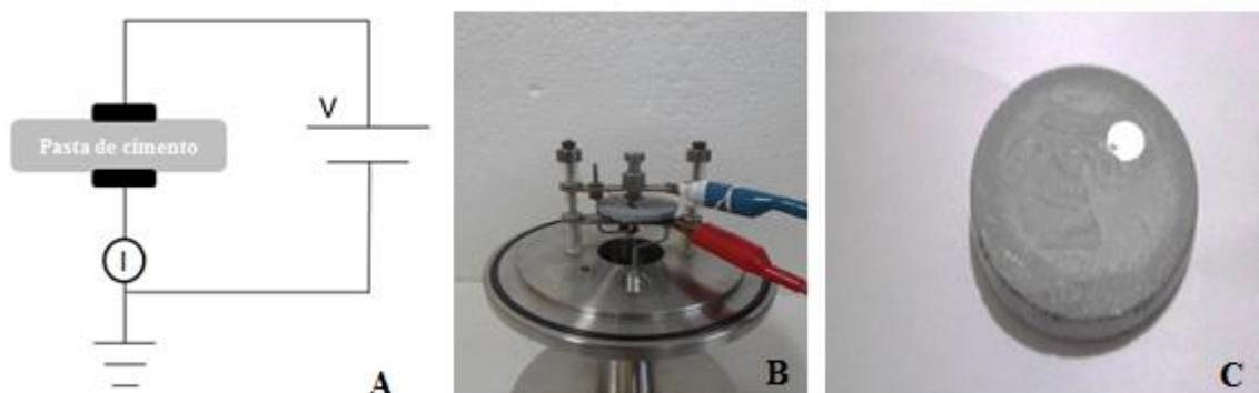
FIG. 5.12 A) Figura esquemática do método das duas pontas, B) detalhe do ensaio realizado e C) amostra com a tinta prata em uma das faces.
