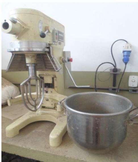
FIG. 5.3 Argamassadeira utilizada para confecção das argamassas.
