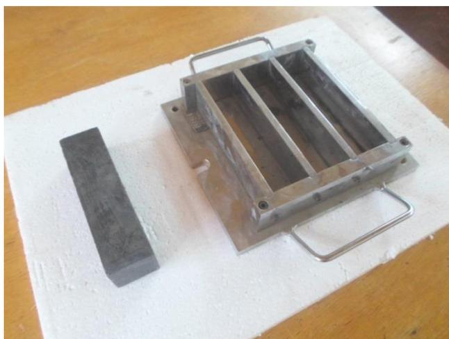
FIG. 5.4 Forma para confecção dos corpos-de-prova prismáticos.
