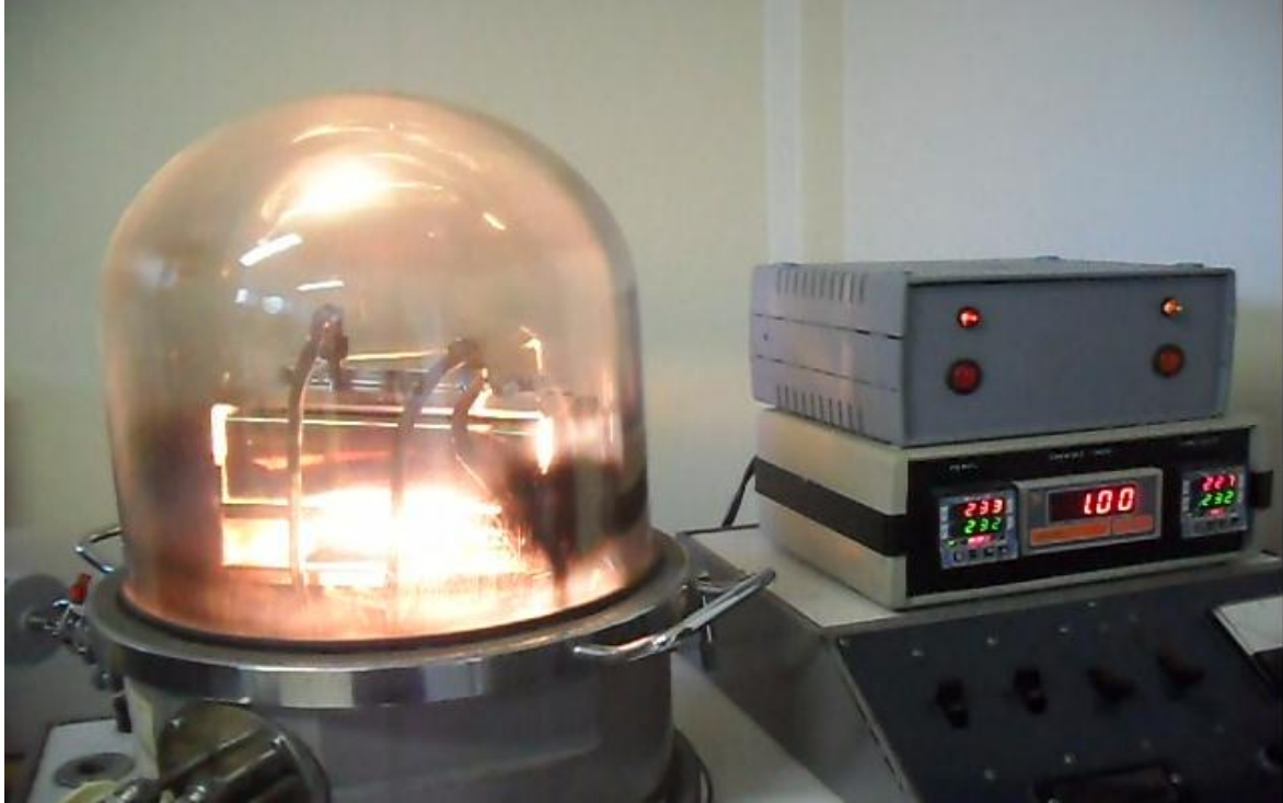
FIG. 3.1. Equipamento para deposição de ZnTe por CSS.
