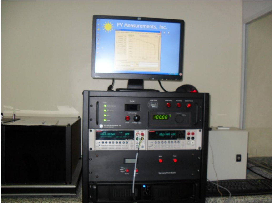
FIG 3.7. Equipamento usado para medidas J \times V .
