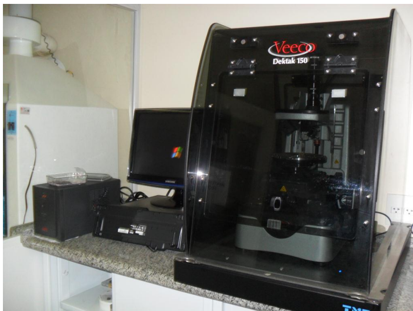
FIG 3.3. Perfilômetro utilizado nas medidas de espessura.
