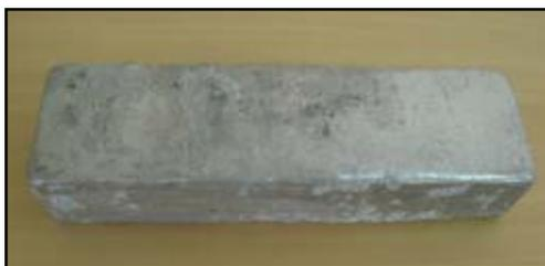
**FIG. 3.15 Barra de alumino/silício gerado após solidificação**
