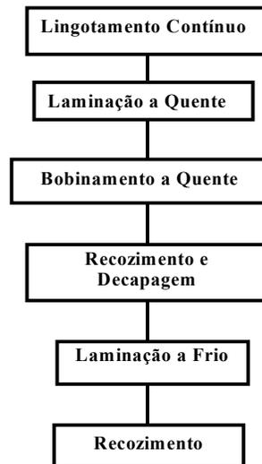
**FIG. 2.6** Processo convencional de fabricação dos aços elétricos
