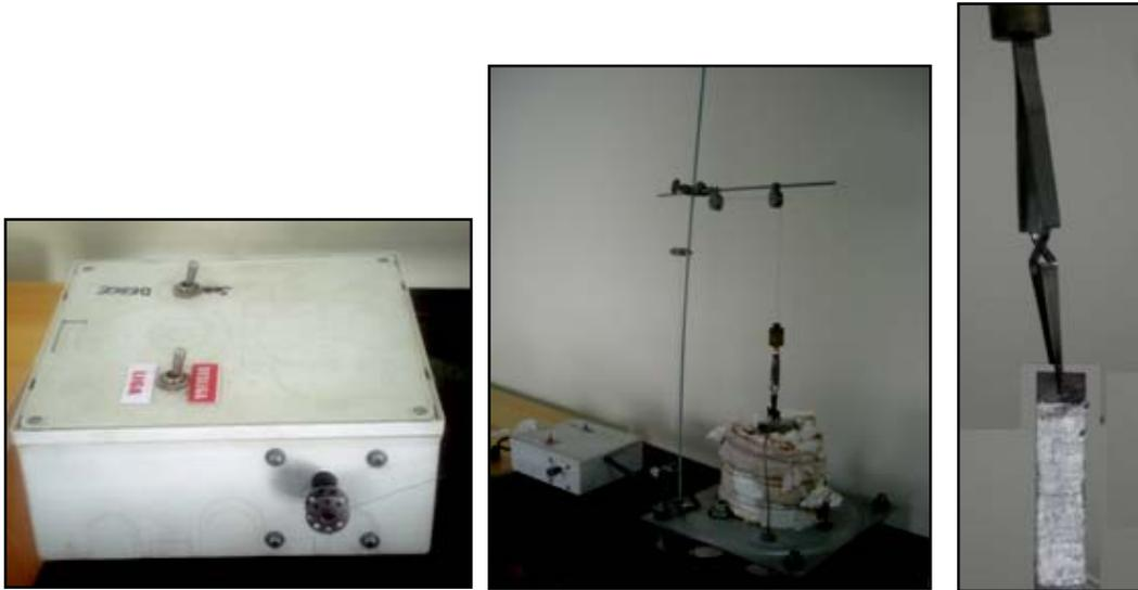
**FIG. 3.10** Dispositivo de imersão para controle de velocidade
