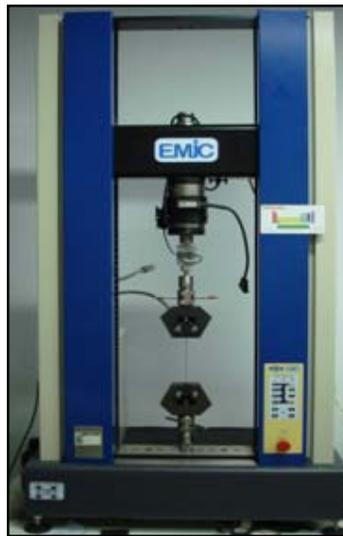
**FIG. 3.29** Máquina EMIC Universal para ensaios mecânicos
